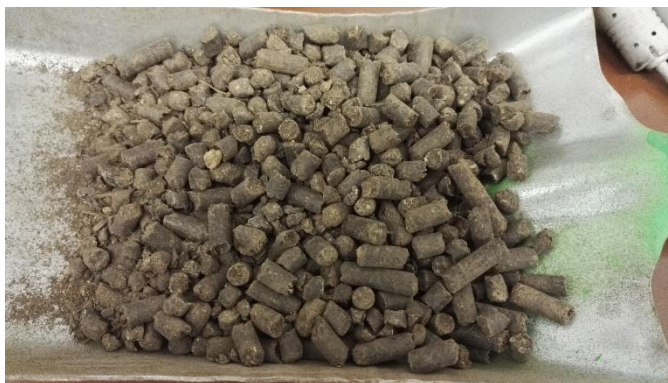
Obr. 9: Pelety z digestátu o průměru 6 mm
