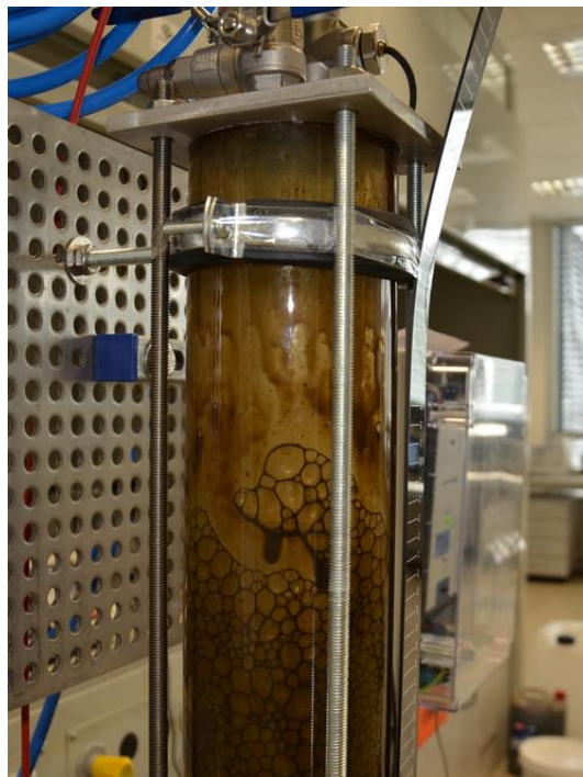
Obr. 35 Kolaps pěny při měření č.4.
