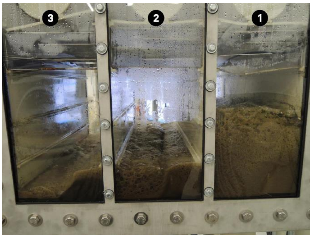
Obr. 8 Pěnění fugátu během zahušťovacího experimentu v MSF odparce: (1.)–(3.) stupeň odparky [6].
