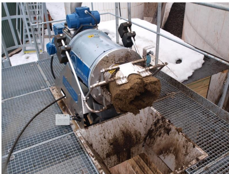
Obr. 3 Separace digestátu – šnekový lis [13].
