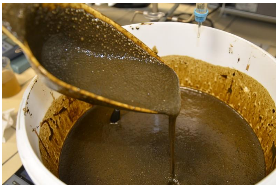
Obr. 24 Pění způsobené snižováním pH.
