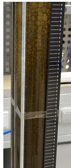
Obr. 15 Struktura pěny fugátu v experimentální koloně.
