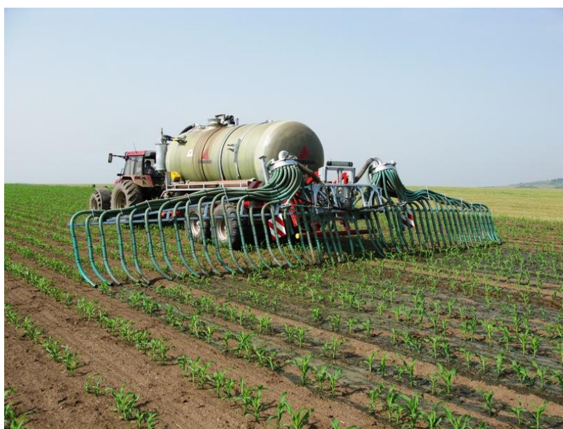
Obr. 5 Hadicový aplikátor digestátu v Suchohrdlích u Miroslavi [15].
