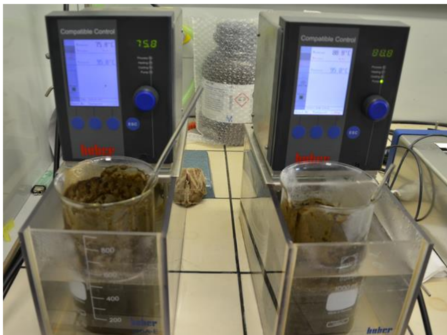
Obr. 31 Ohřev vzorků fugátu ve vodní ohřevné lázni HUBER.
