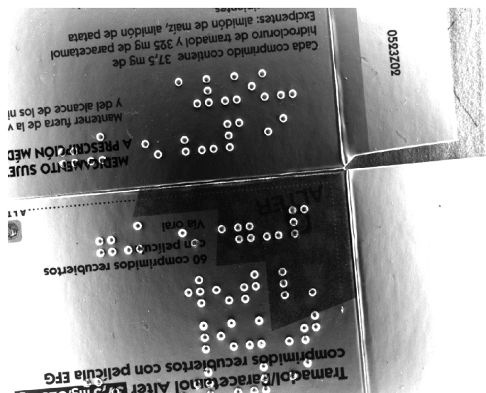
Obr. 4.10: Snímek složený ze 4 snímků s výstupem intenzity
