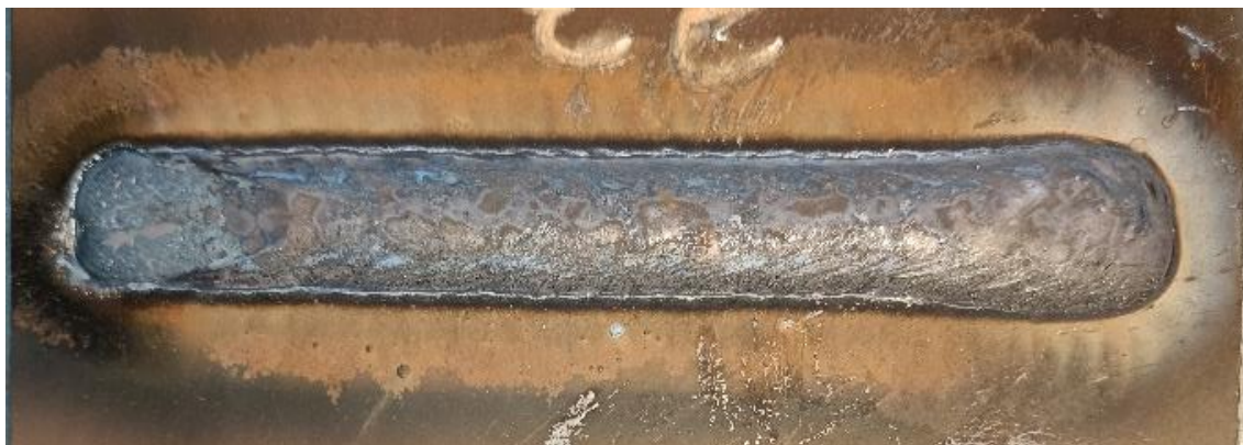
Obr. 44 Svar 10 mm 300 A 30,5 °C.
