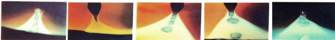
Obr. 28 Průběh přenosu kovu při svařování rotující m přenosem [8].
