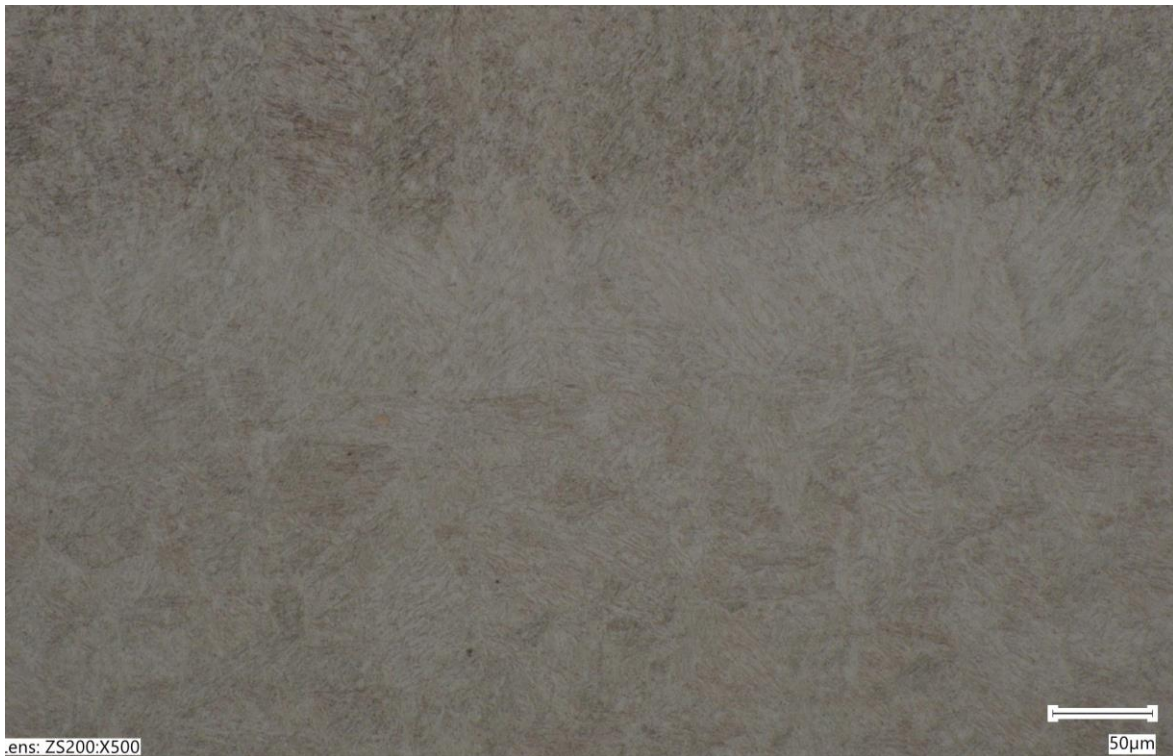
Obr. 79 Rozhraní návarového a základního materiálu.
