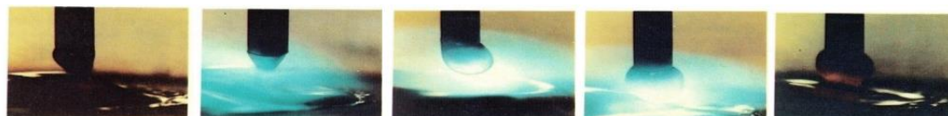
Obr. 25 Průběh přenosu kovu při zkratovém svařování [8].
