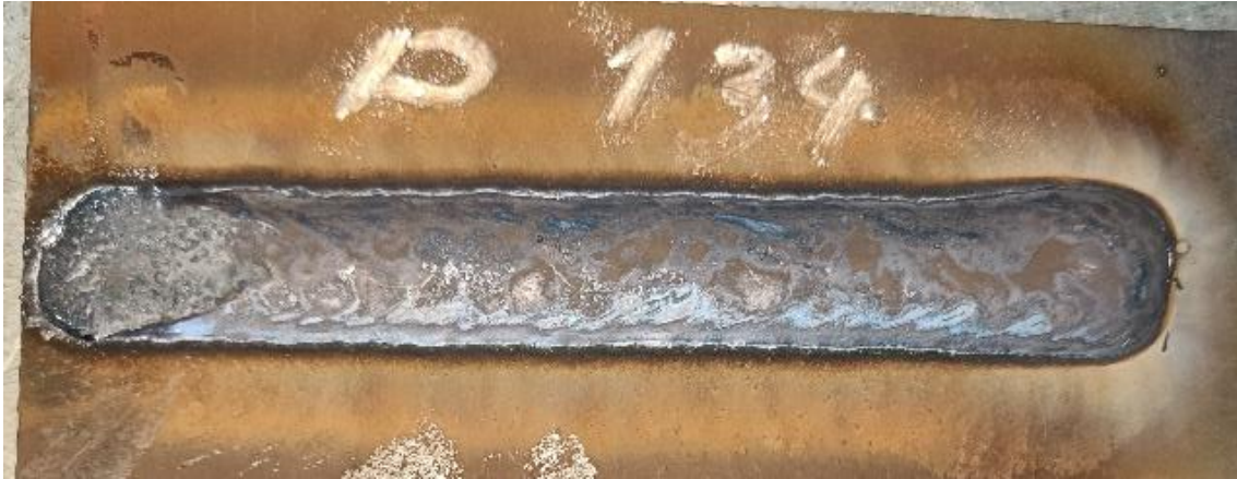
Obr. 45 Svar 10 mm 300 A 134,9 °C.
