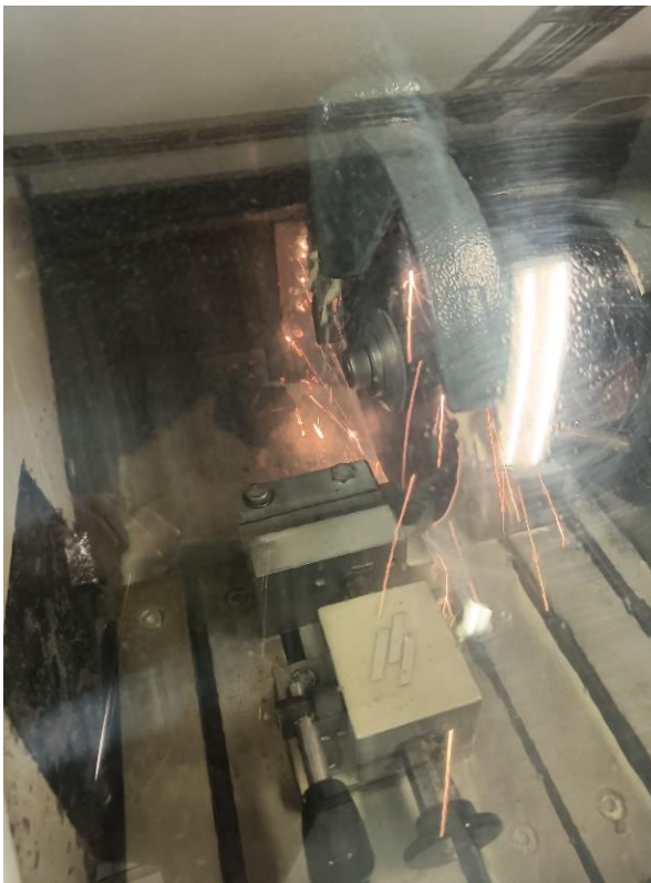
Obr. 46 Dělení s chladicí emulzí.
