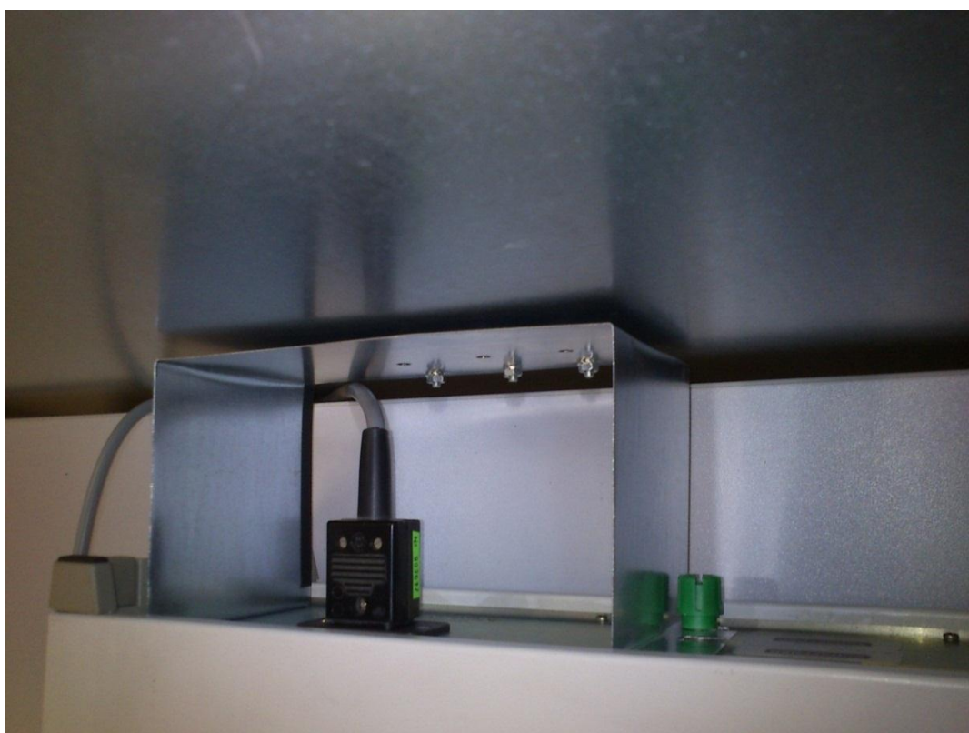
Obr. 11: Detail spojení umělé sítě LISN se referenční zemní rovinou
