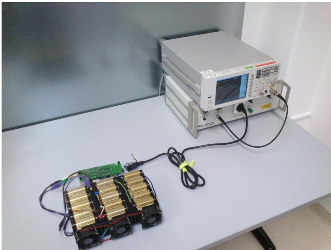
Obr. 10: Měření rušení spínaného zdroje na pracovišti ON Semiconductor
