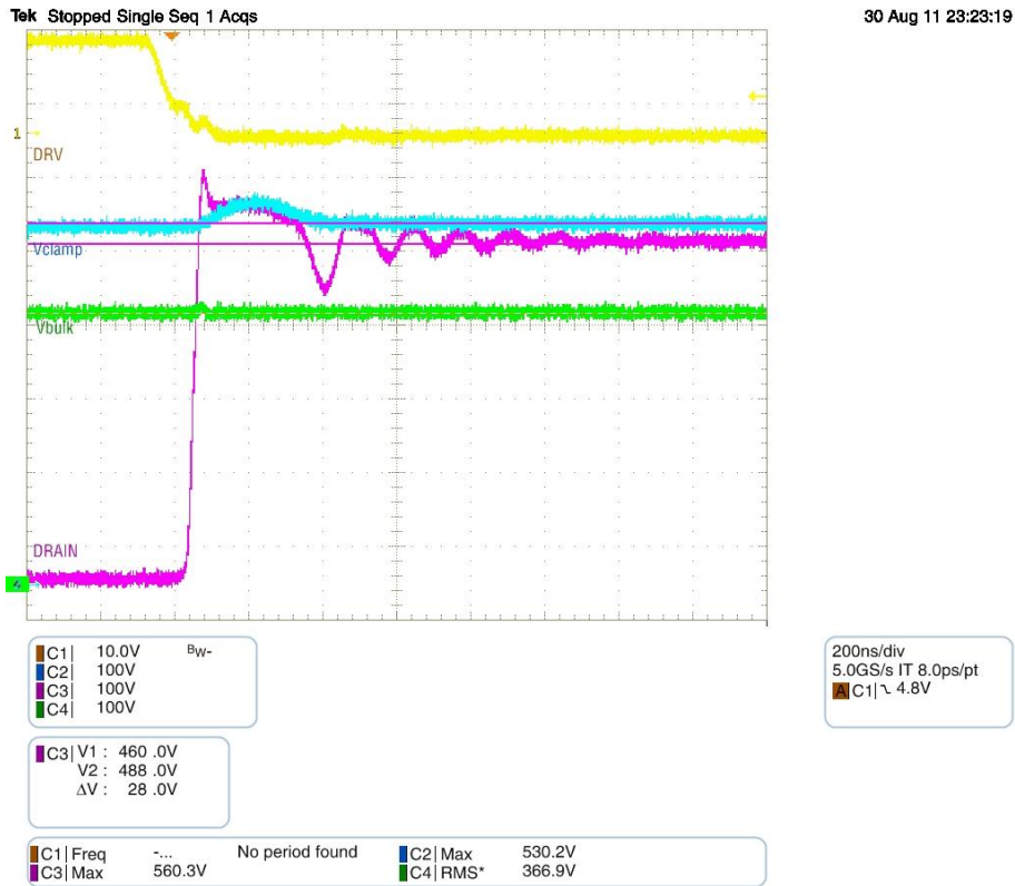
Obr. 24: Tvar překmitu při použití diody 1N4007
