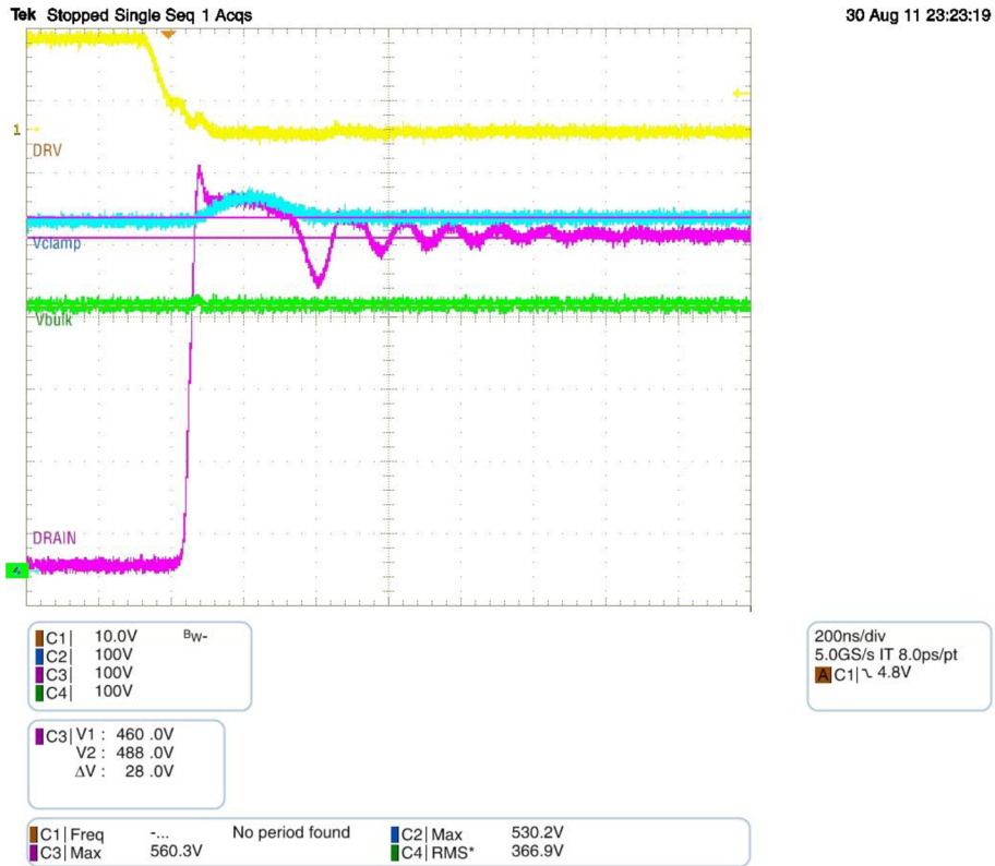
Obr. 24: Tvar překmitu při použití diody 1N4007
