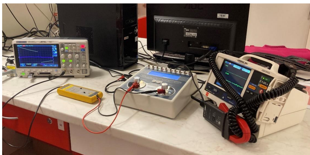
Obr. 10 Měření prováděné na testeru defibrilátorů (zdroj: autor)
