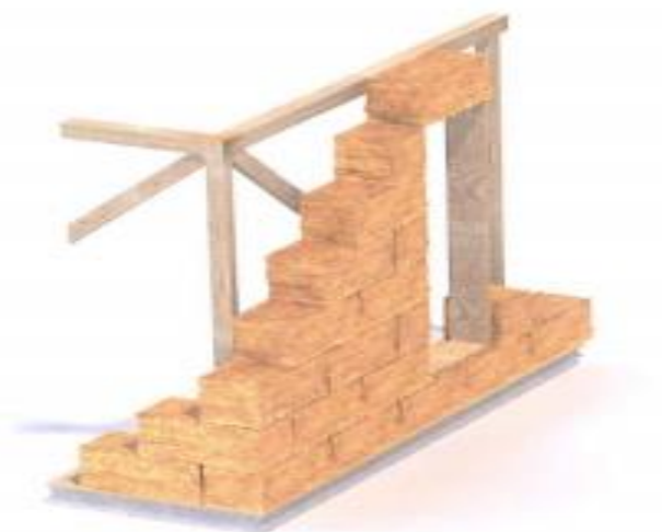
Obrázek 1: Sláma ve skeletovém systému. (Chybík, 2009)
