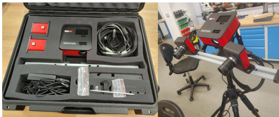
Obrázek 6.8: 3D skener strukturovaného světla RangeVision Spectrum rozložený v přepravním boxu a sestavený na trojnožce (Zdroj: autor)
