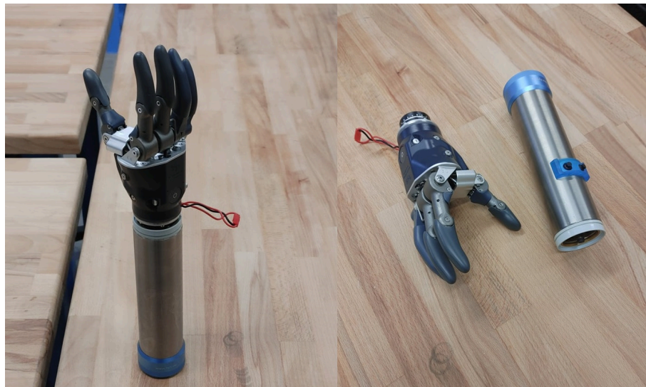
Obrázek 2.6: Hydraulická protéza MyHand od firmy Hy5, složená a rozložená na akční člen a pohybující se ruku (Zdroj: autor)
