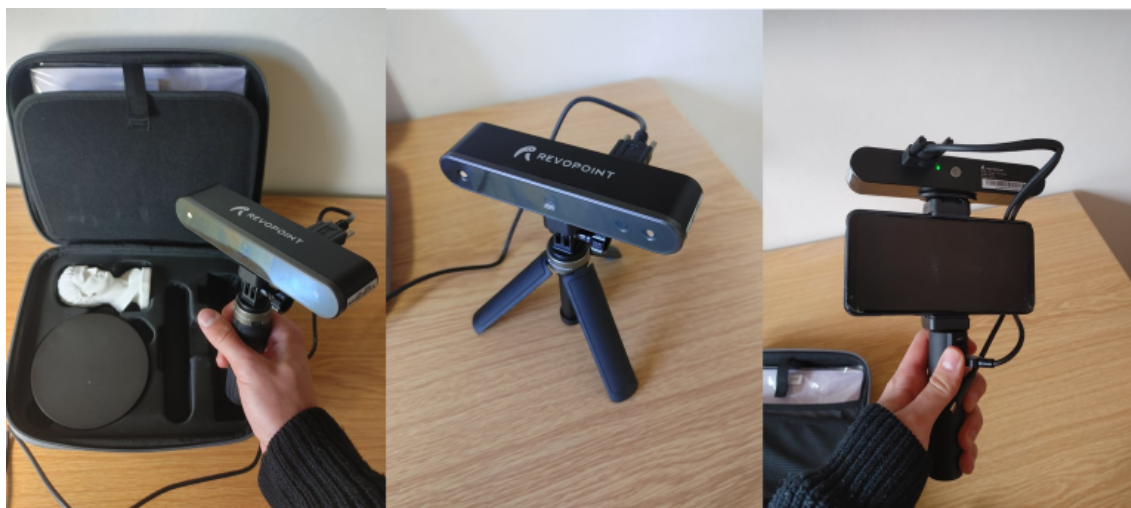
Obrázek 6.15: Skener Revopoint POP 2 s držákem/trojnožkou připojený k počítači a s powerbankou a mobilním telefonem (Zdroj: autor)
