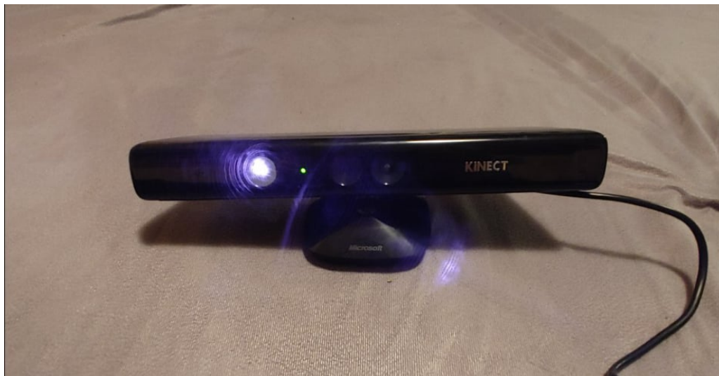
Obrázek 3.5: Microsoft Kinect při snímání hloubky (Zdroj: autor)
