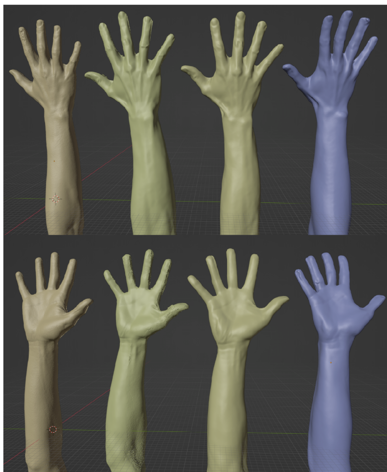
Obrázek 7.10: Modely živé ruky bez úpravy artefaktů generované z programu EXScan Pro za použití skeneru Einscan Pro 2X Plus (Zdroj: autor)
