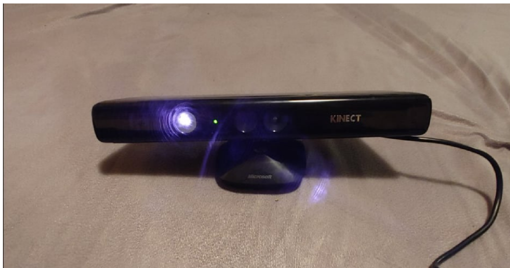
Obrázek 3.5: Microsoft Kinect při snímání hloubky (Zdroj: autor)
