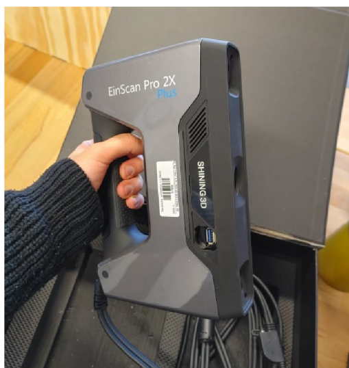
Obrázek 6.11: Skener strukturovaného světla Einscan Pro 2X Plus (Zdroj: autor)
