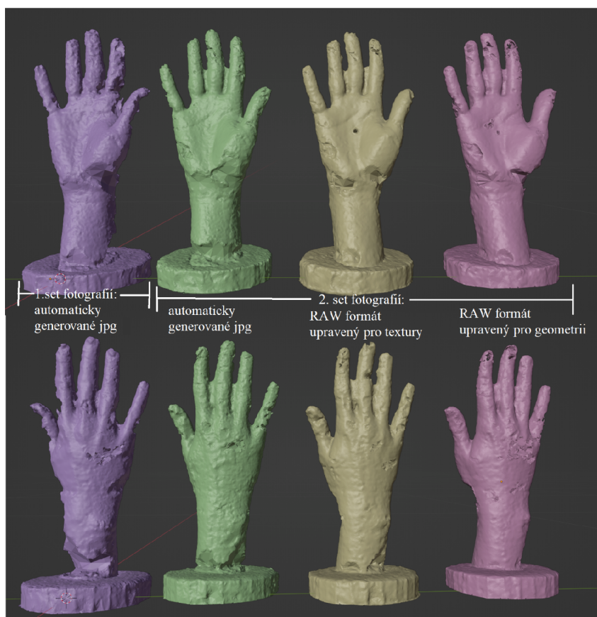
Obrázek 7.6: Modely bez úpravy artefaktů z fotogrammetrického programu Meshroom (Zdroj: autor)
