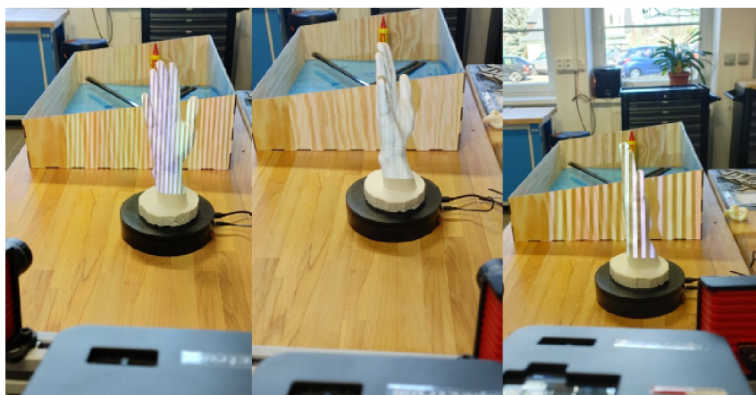
Obrázek 6.9: Projekce strukturovaného světla skeneru Rangevision Spectrum (Zdroj: autor)
