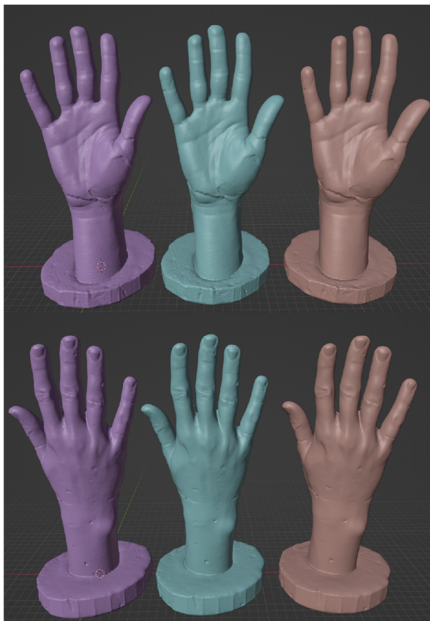
Obrázek 7.9: Modely bez úpravy artefaktů generované z programu EXScan Pro za použití skeneru Einscan Pro 2X Plus (Zdroj: autor)
