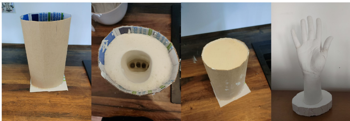
Obrázek 6.1: Proces výroby sádrového odlitku pro další skenování (Zdroj: autor)
