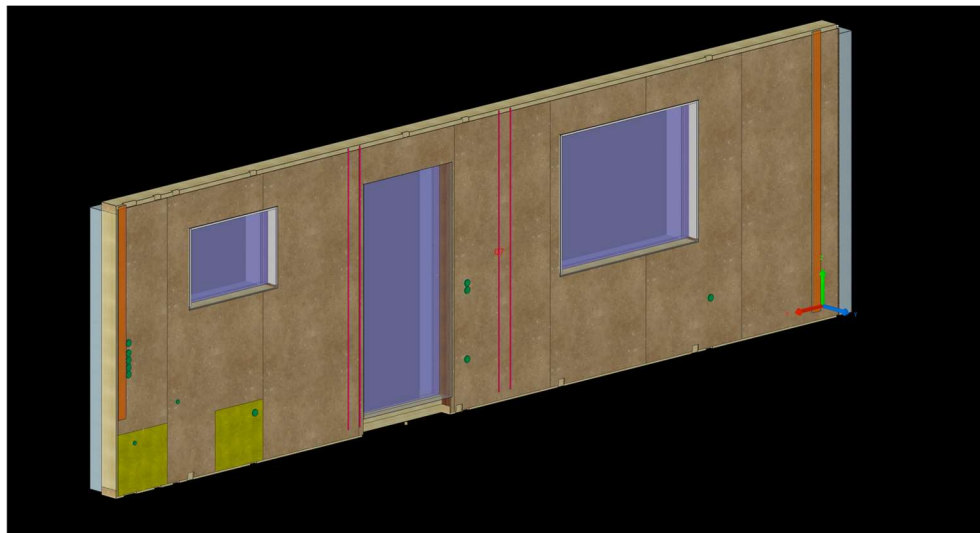
Obrázek 13 Rozdělení OSB u obvodové stěny
