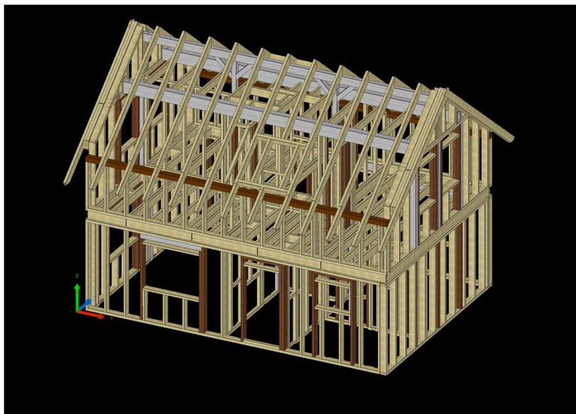
Obrázek 19 Dřevěná konstrukce dřevostavby
