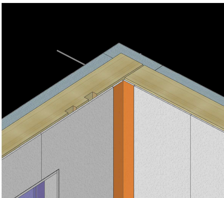
Obrázek 16 Napojení obvodových panelů
