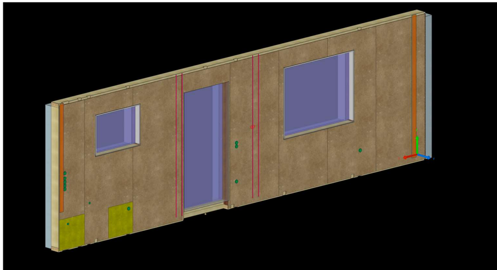
Obrázek 13 Rozdělení OSB u obvodové stěny
