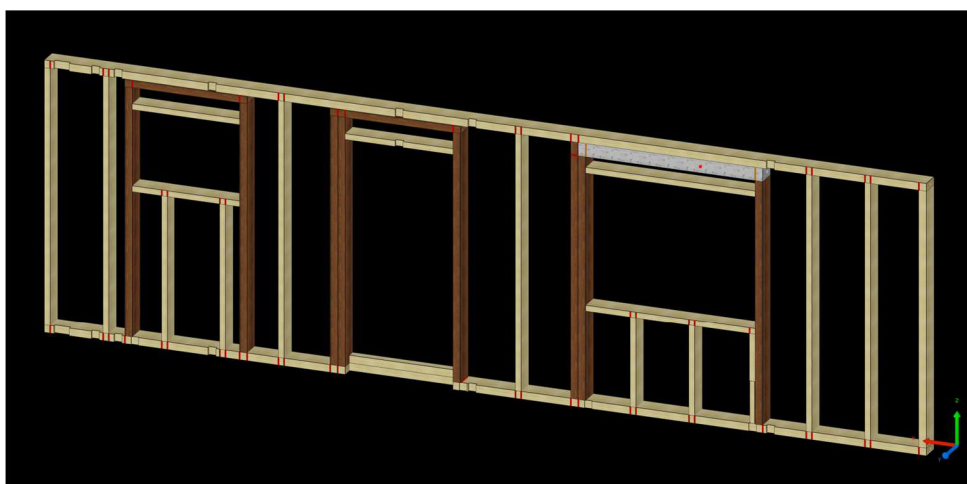
Obrázek 12 Sloupková konstrukce stěny
