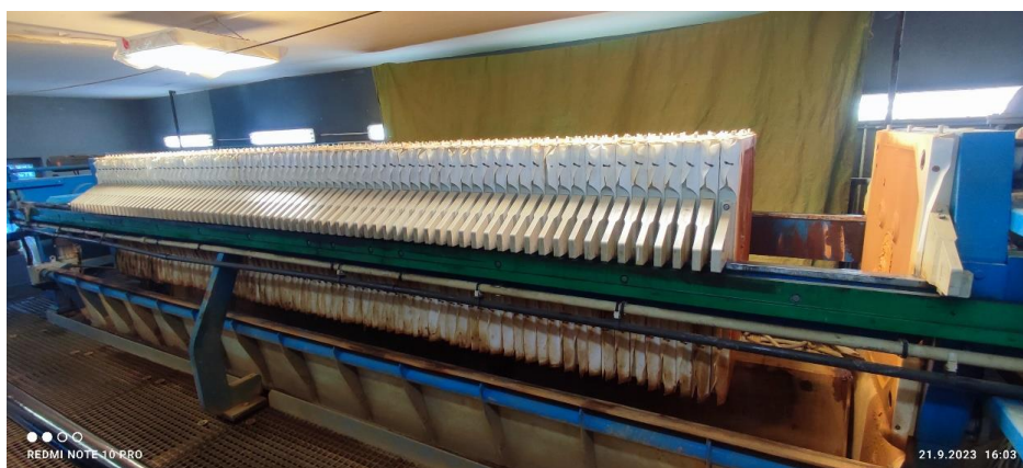
Obrázek 36: Komorový filtrační kalolis KK 800/80 (Kurtík, 2023).
