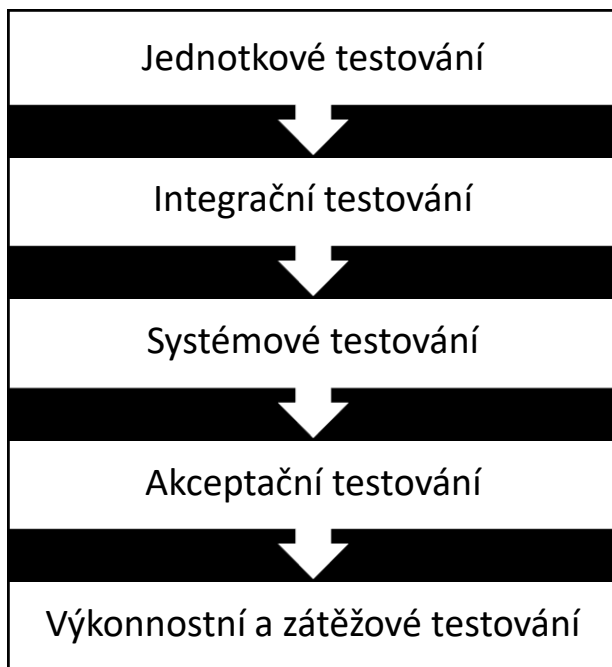
Schéma 1 - Znázornění schématu posloupnosti testovacího procesu Zdroj: vlastní tvorba
