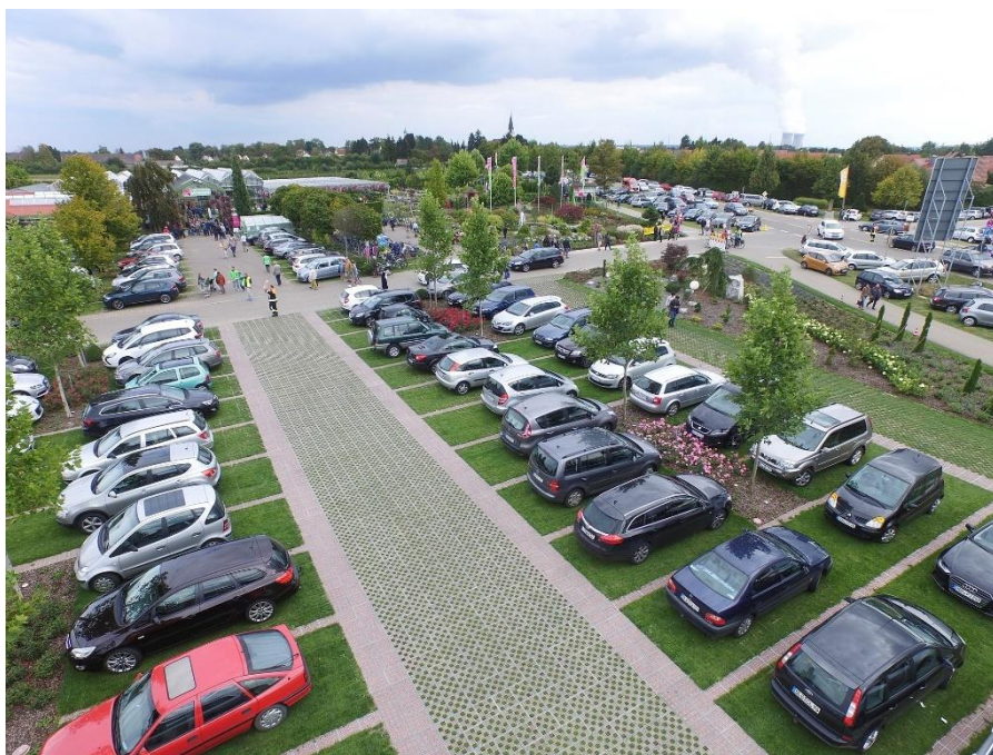
Obr. č. 8: Propustné zpevňující rošty s vegetační výplní (Tzb-info.cz, 2018)
