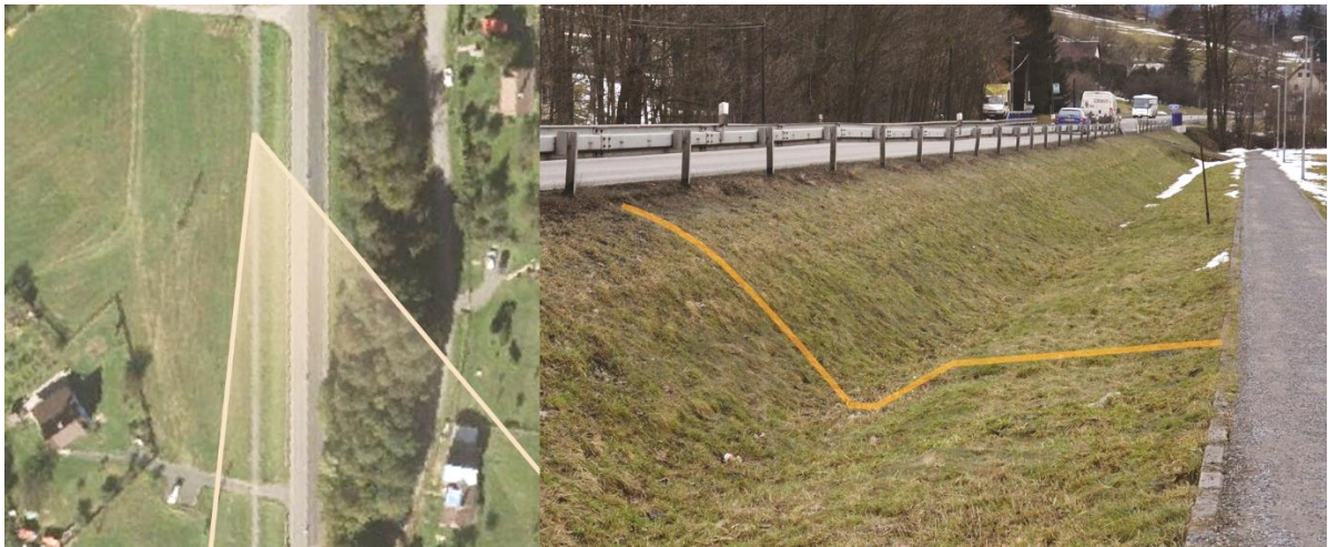
Obr. č. 13: Příkop v Rožnově pod Radhoštěm a jeho příčný řez (ČÚZK, vlastní zpracování, 2020)
