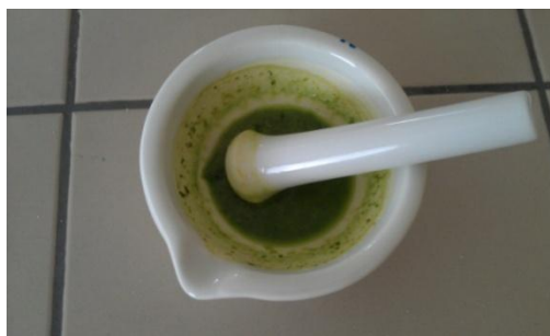
Obrázek 6 - Izolace chlorofylu třením rostlinného materiálu a extrakcí v acetonu
