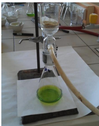
Obrázek 7 - Oddělení pevných částic od zkoumaného extraktu za sníženého tlaku
