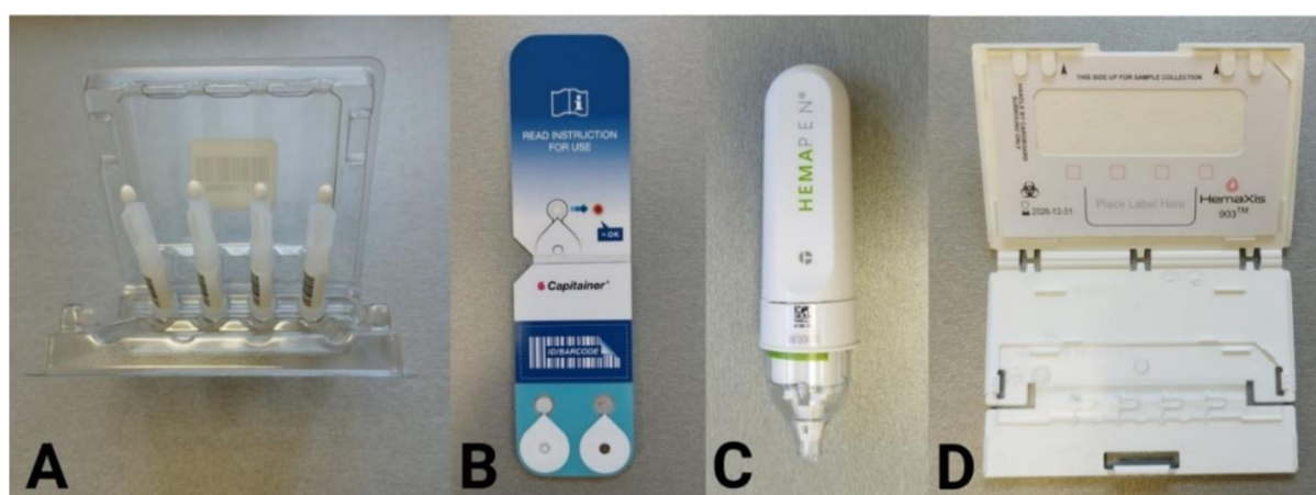
Obrázek 2: Volumetrická odběrová zařízení (A...Mitra, B...Capitainer-B, C...HemaPEN, D...HemaXis DB10)
