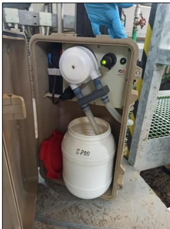
Obrázek 26: Připravené mobilní automatické vzorkovací odběrové zařízení na přítoku do ČOV.
