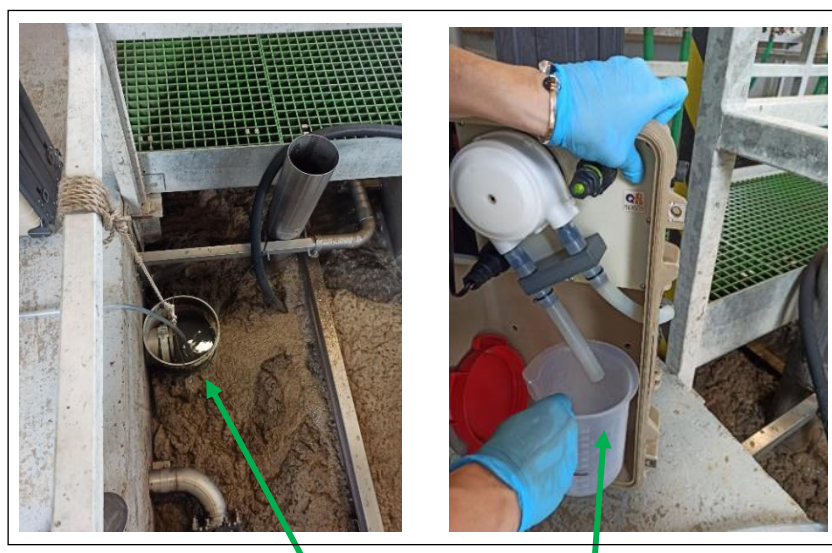
Obrázek 25: Ponořená odběrová sonda a odběr 400 ml odpadní vody pro kalibraci zařízení.
