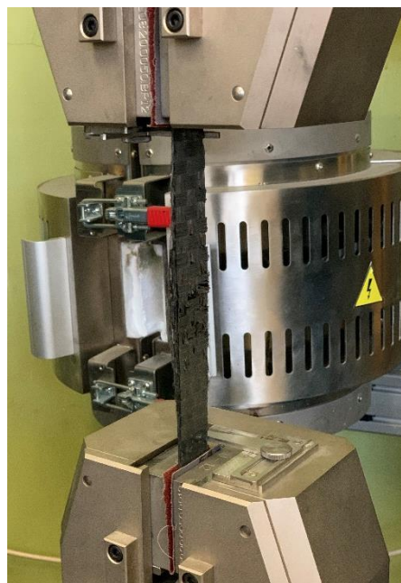
Obr. 3.2 Přetržený vzorek v čelistech
