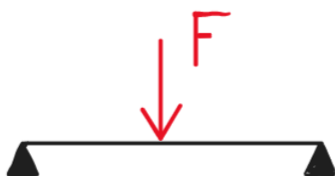
Obr.2.12 Princip třibodové ohybové zkoušky
