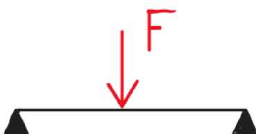
Obr.2.12 Princip třibodové ohybové zkoušky
