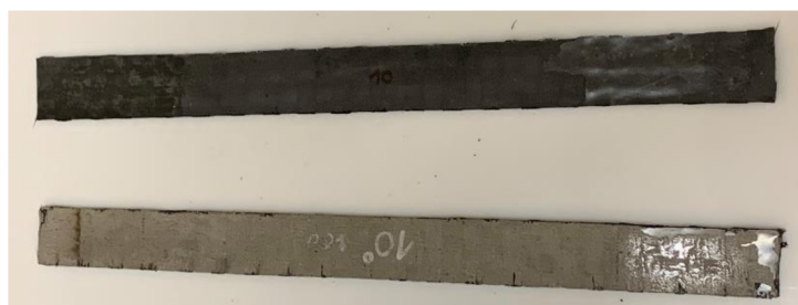
Obr. 3.8 Změna barvy vzorku po vystavení vysoké teplotě
