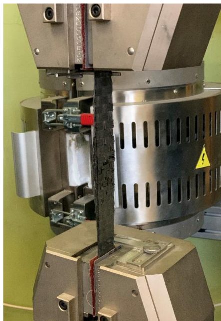
Obr. 3.2 Přetržený vzorek v čelistech
