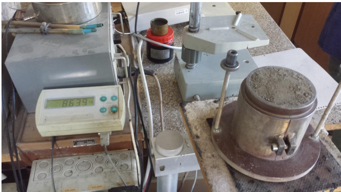
Obrázok 20: Váženie zmesi spolu s formou po hutnení Proctorovým mechanizmom [17]
