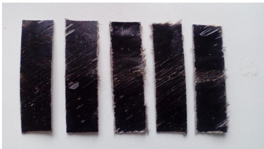
Obrázek 3.5- Poškozené vzorky z čedičových vláken po zkoušce měření modulu pružnosti ohybu a napětí v ohybu na přístroji dynamometr pro 3-bodý ohyb.
