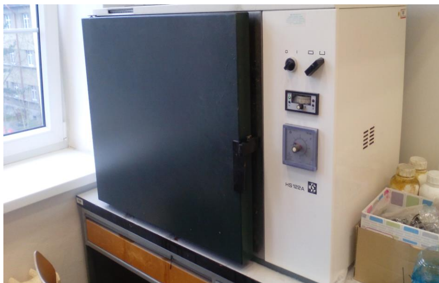
Obrázek 2.6- Pec HS 122A na vytvrzování matrice.
