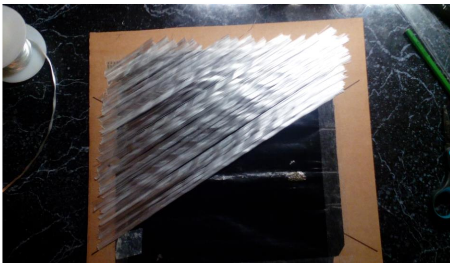
Obrázek 2.1- Příprava kompozitu ze skleněných vláken.
