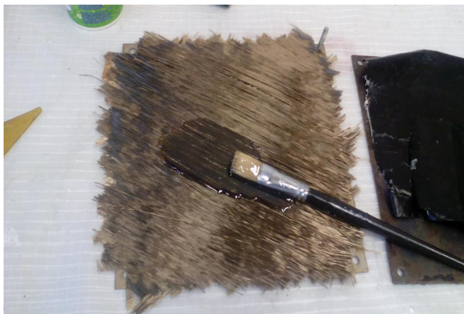
Obrázek 2.4- Nanášení matrice na vzorek z čedičových vláken.
