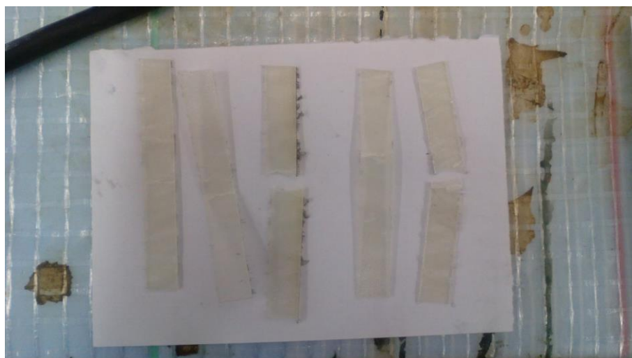
Obrázek 3.2- Přeražené vzorky ze skleněných vláken pod úhlem 60°, po zkouše na přístroji Charpyho kladivo.
