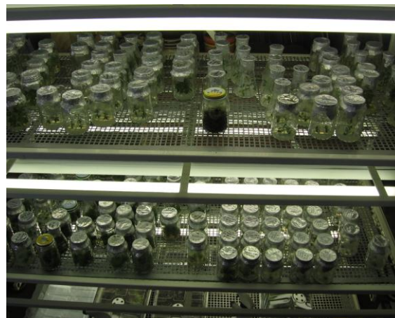
obr. 2 Stojan s fluorescenčními zářivkami pro kultivaci rostlin in-vitro bez přesně definovaného teplotního režimu
