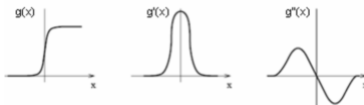
Obrázek 3.2: Průběh obrazové funkce: a) původní funkce; b) první derivace; c) druhá derivace (převzato ze [7])
