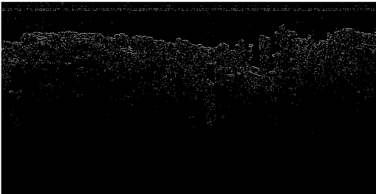
Obrázek 6.2: Hrany detekované pomocí Robertsova hranového detektoru
