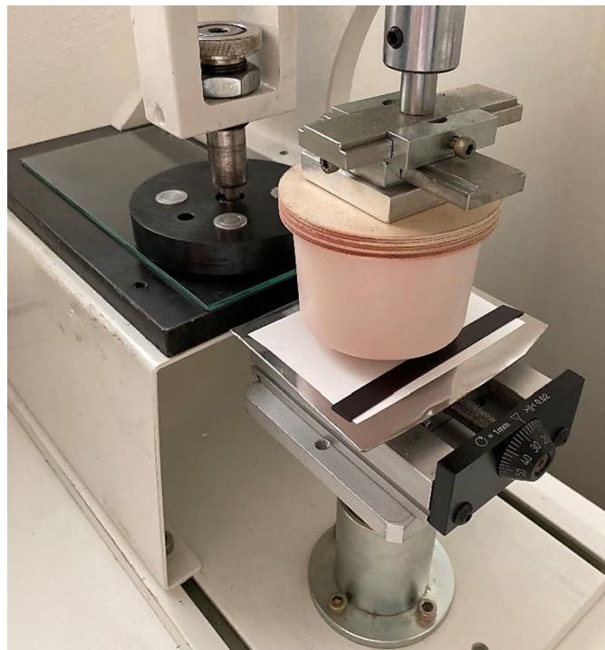
Obrázok 28 – Tlač značky tampónovým tlačovým strojom na ISO papier
