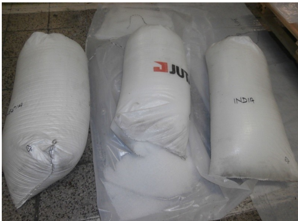
Obrázek 29 - Pádová zkouška, poškození pytlů[19]
