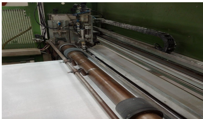
Obrázek 21 - ultrazvukové řezání tkaniny[12].
