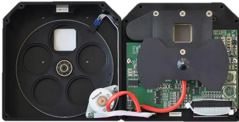
Obr. 25: Vnitřní elektronika CCD kamery G2-3200 [16]
