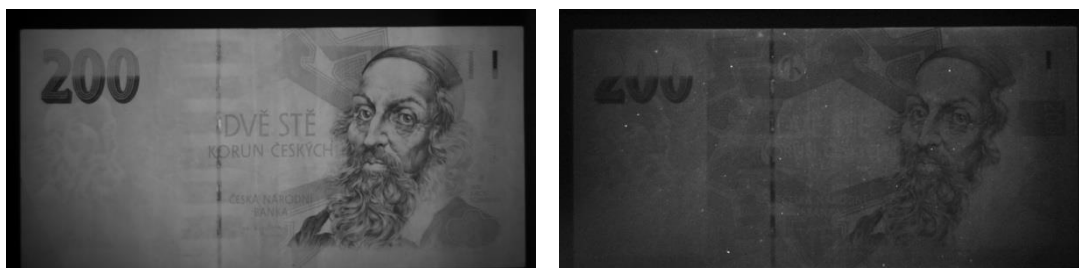
Obr. 60: Ochranné UV prvky na 200 Kč bankovce ( v = 4000 \text{ ot.min}^{-1} , t = 300 \text{ s} )
