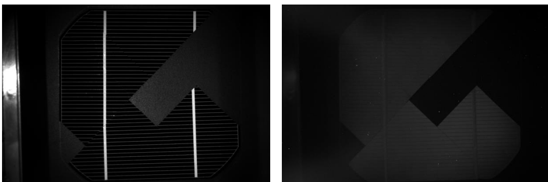
Obr. 35: Článek B měřený pomocí fotoluminiscence ( v = 8000 ot.min -1 , t = 600 s)
