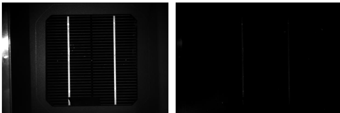
Obr. 30: Článek 4 měřený pomocí fotoluminiscence ( \nu = 8000 \text{ ot.min}^{-1} , t = 300 \text{ s} )
