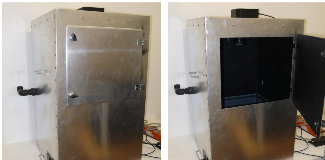
Obr. 16: Laboratorní box pro měření metodou elektroluminiscence
