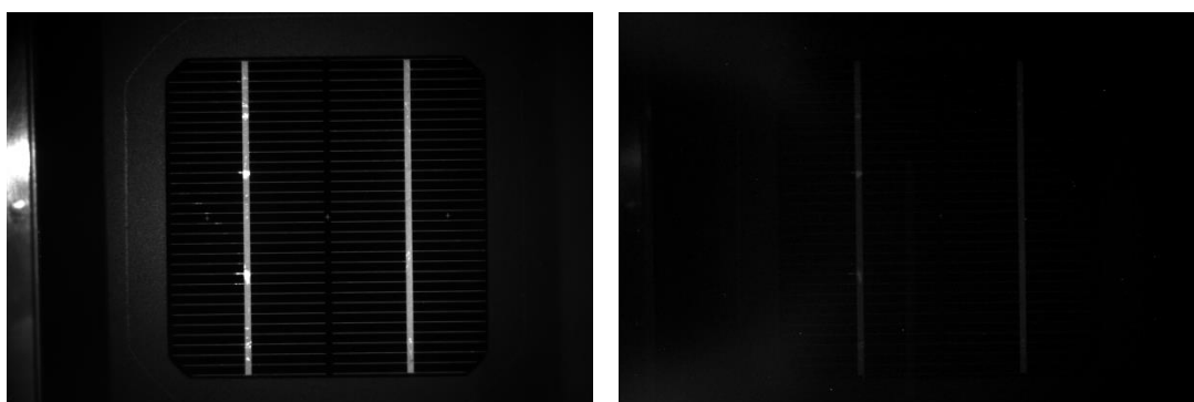
Obr. 29: Článek 3 měřený pomocí fotoluminiscence ( v = 8000 \text{ ot.min}^{-1} , t = 300 \text{ s} )
