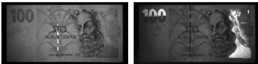
Obr. 59: Ochranné UV prvky na 100 Kč bankovce ( v = 4000 \text{ ot.min}^{-1} , t = 300 \text{ s} )
