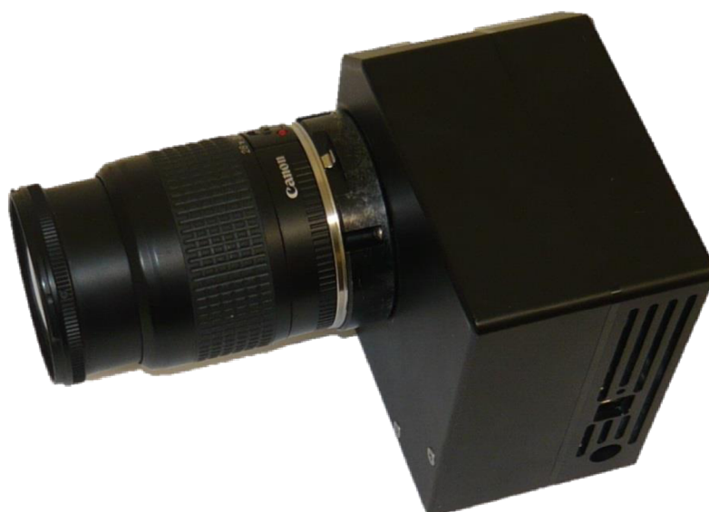
Obr. 24: CCD kamera s nasazeným objektivem
