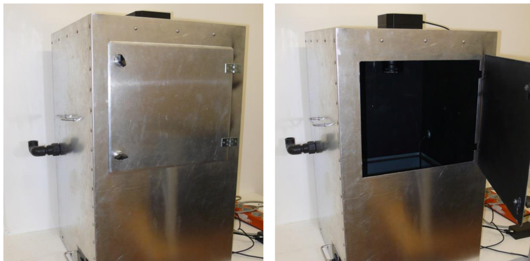
Obr. 16: Laboratorní box pro měření metodou elektroluminiscence
