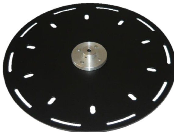
Obr. 43: Vyrobená a testovaná clona 3
