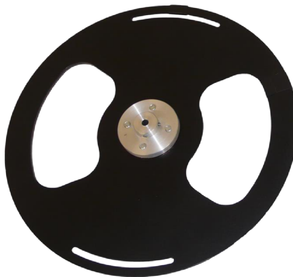
Obr. 27: Vyrobená a ověřovaná clona 1
