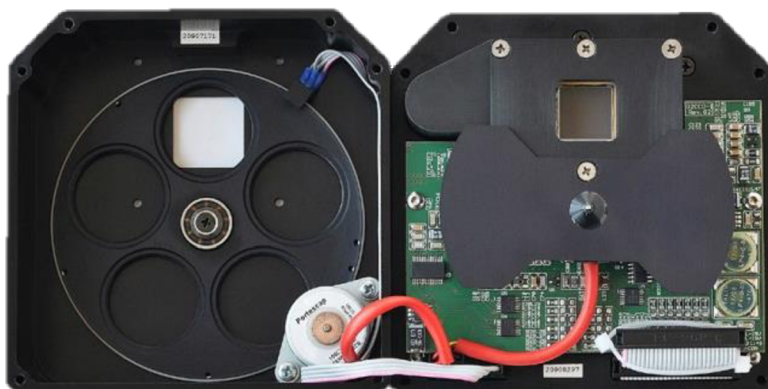
Obr. 25: Vnitřní elektronika CCD kamery G2-3200 [16]
