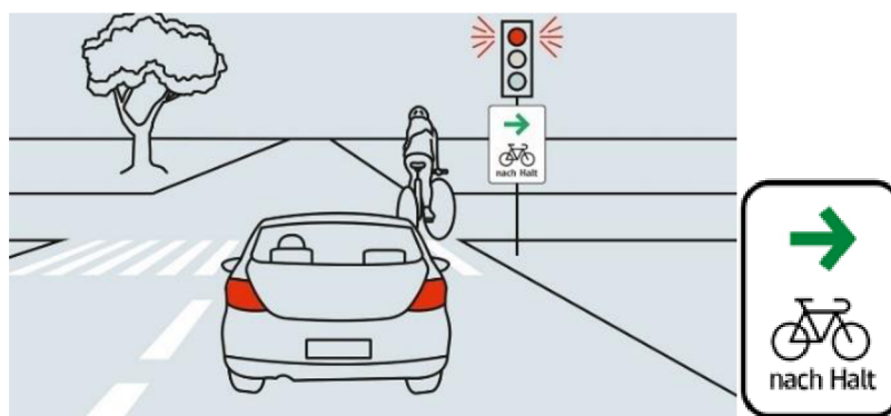
Obr.7 Dopravní značení umožňující cyklistům odbočení vpravo během červeného signálu „stůj“
