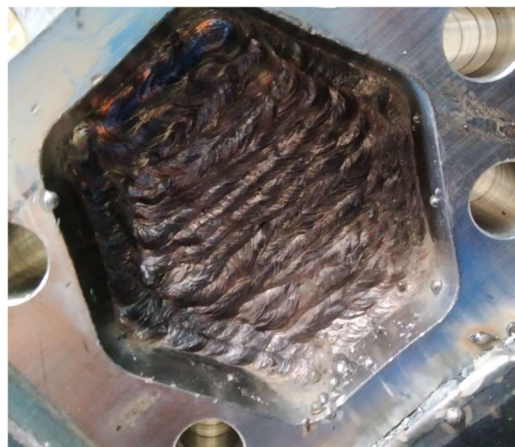
Obr 44 2. fáze svařování KSS 760
