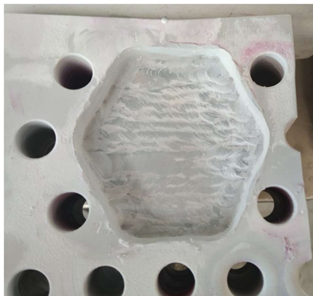
Obr. 55 Smrštění viditelné po PT
