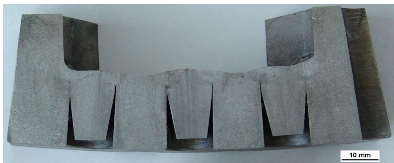
Obr. 56 Zavařené zátky KSS 762B
