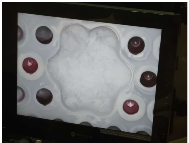
Obr. 65 Vyhovující kapilární kontrola
