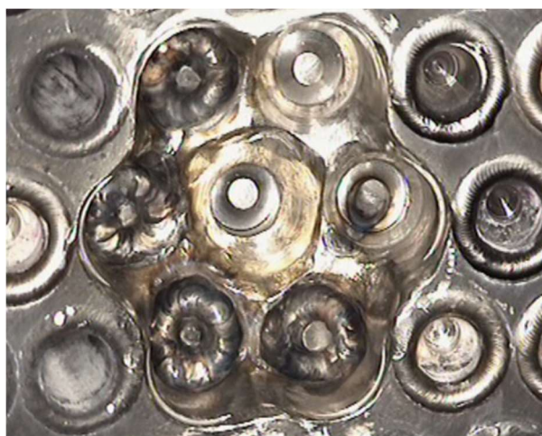
Obr. 59 Svařování první vrstvy
