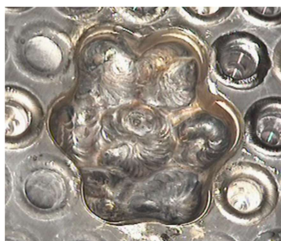
Obr. 60 Po svaření druhé vrstvy
