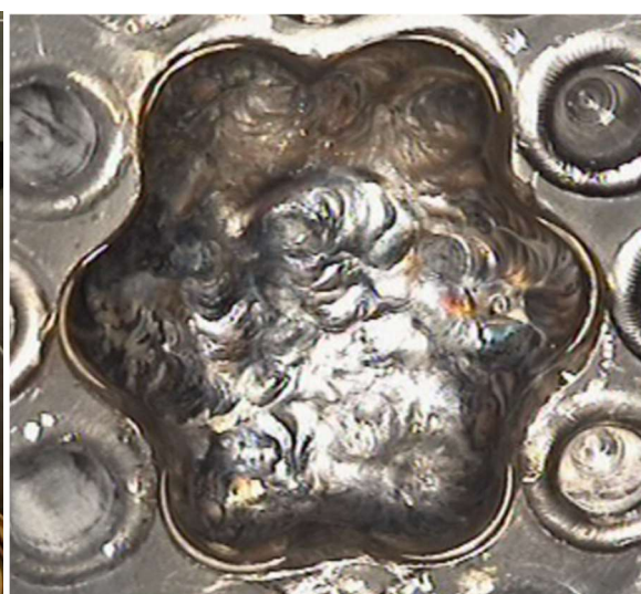
Obr. 62 Zavařená třetí vrstva
