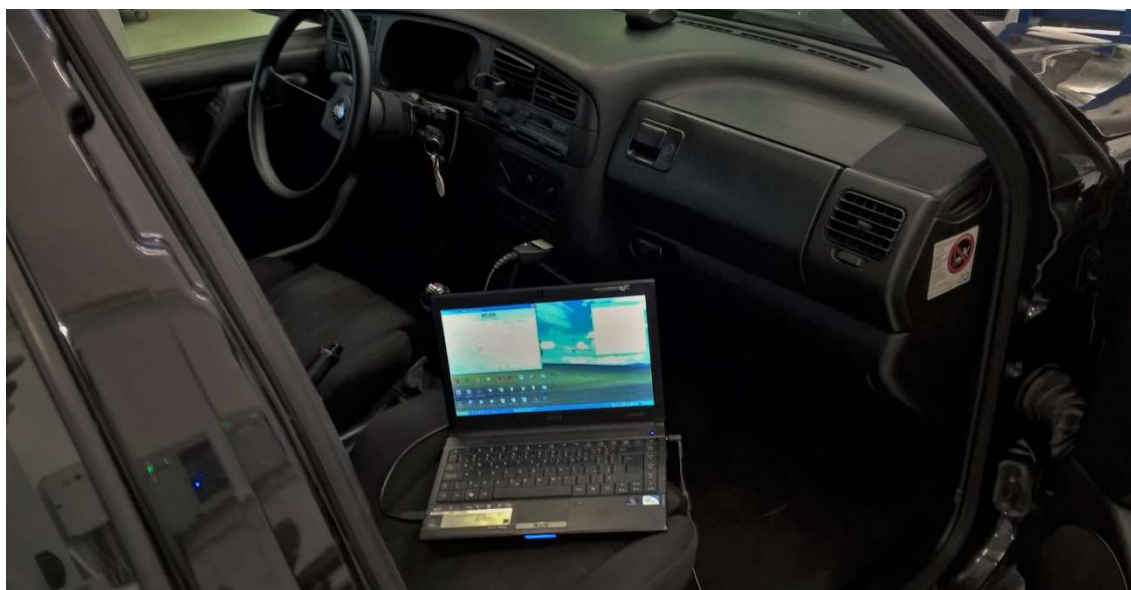
Obrázek 8-5 Notebook s diagnostikou napojený na OBD zásuvku
