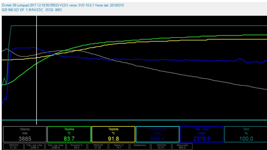
Obrázek 9-2 údaje z OBD při měření výkonu s upravenou jednotkou
