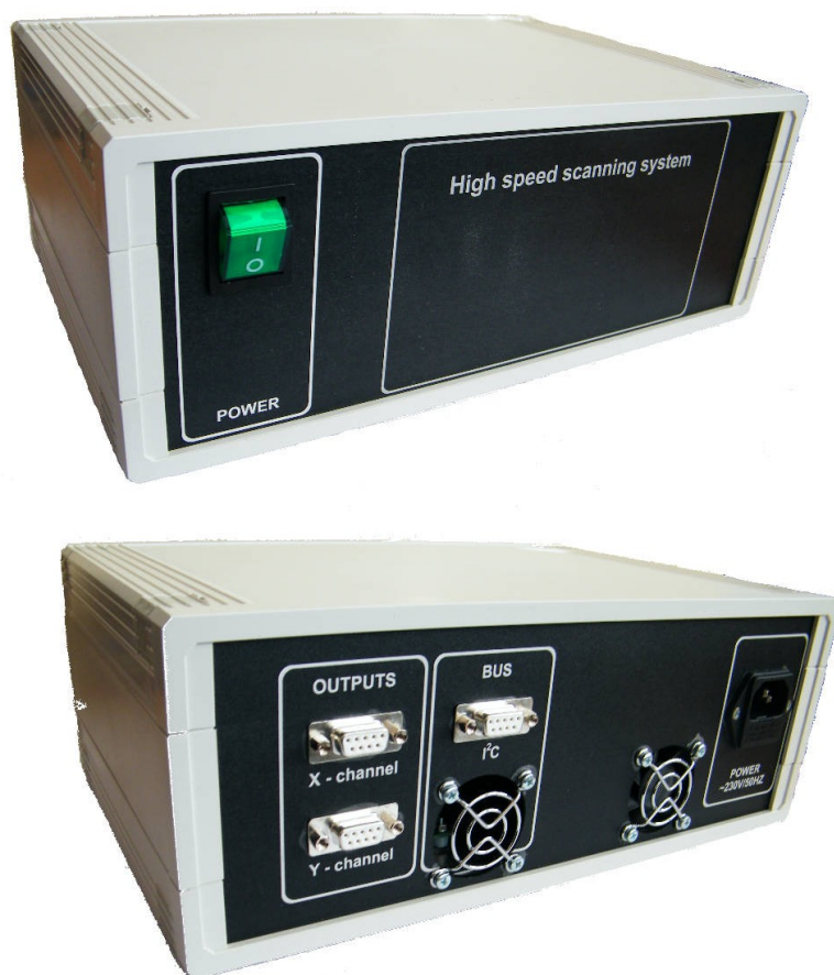
Obr. 7.20 Pohled na kompletní jednotku ovládání galvozrcadel
