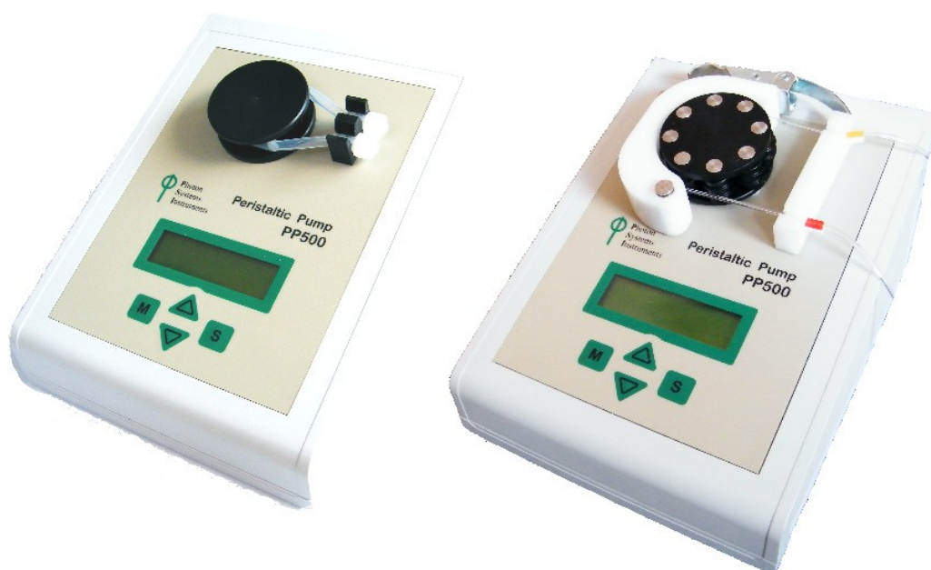
Obr. 7.22 Pumpa PSI původní (vlevo) a upravená pro nízké průtoky kapaliny (vpravo)
