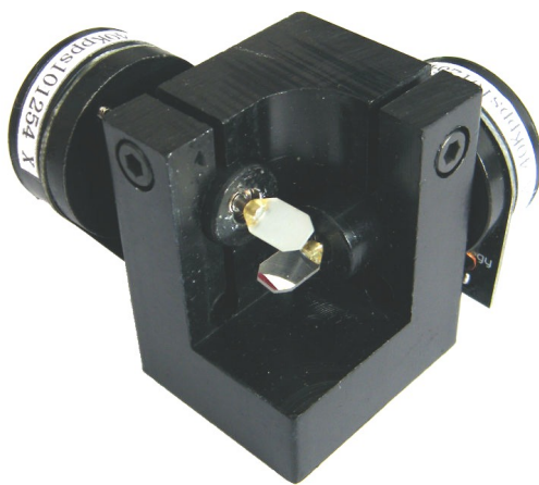
Obr. 7.17 Galva se zrcátky pro vychylování laseru
