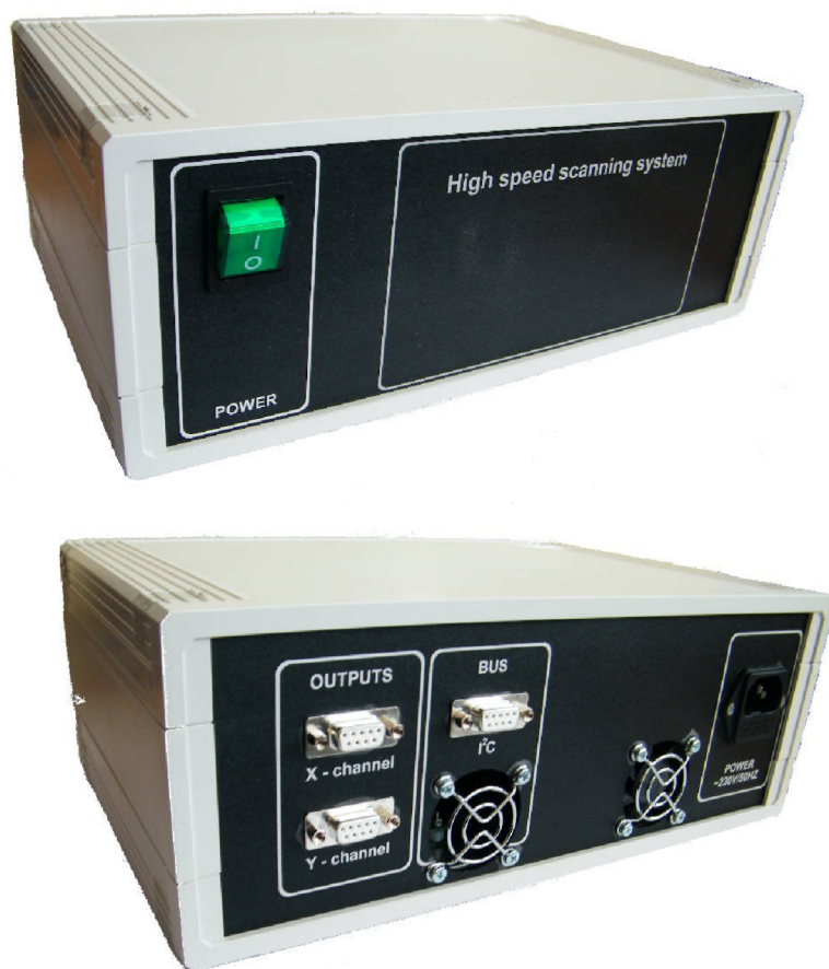
Obr. 7.20 Pohled na kompletní jednotku ovládání galvozrcadel
