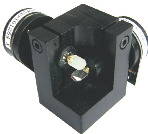
Obr. 7.17 Galva se zrcátky pro vychylování laseru
