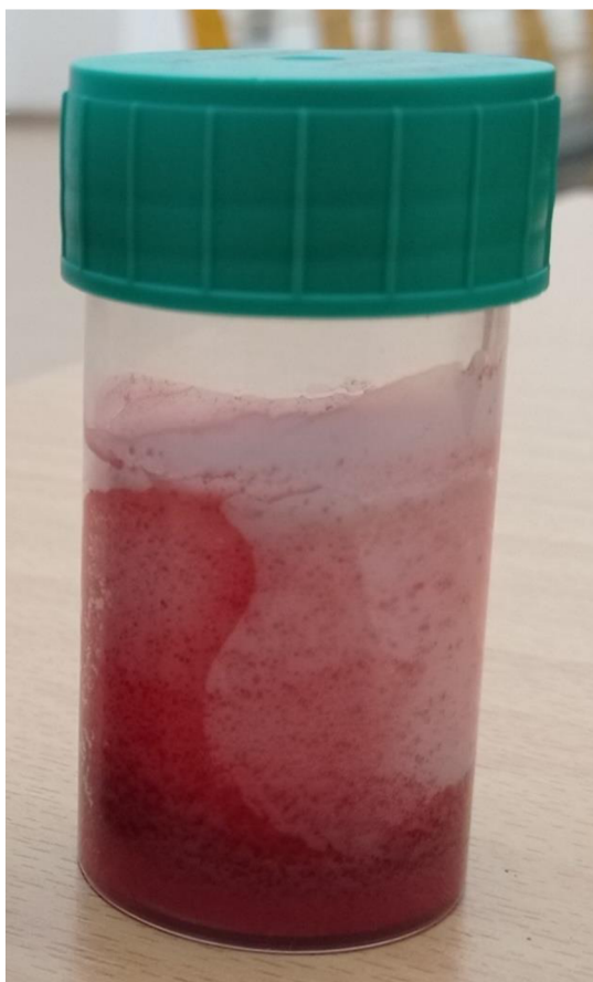
Obrázek 12 - Nedostatečná dispergace vodné složky balzámu a její následná sedimentace
