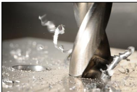
Obr. 2 Vrtání krátkých a dlouhých děr [5].
