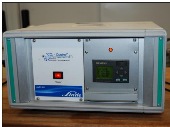
Obr. 46 Řídicí jednotka CO 2 Control a elektronicky řízený ventil s kapilárou.
