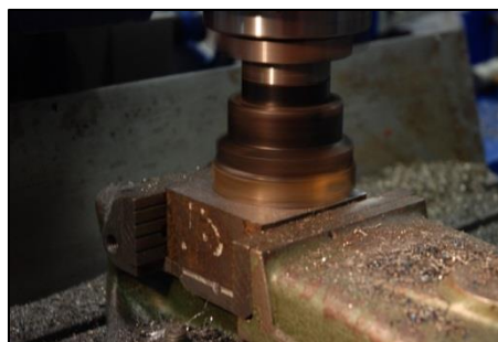
Obr. 40 Frézování na přesný rozměr.
