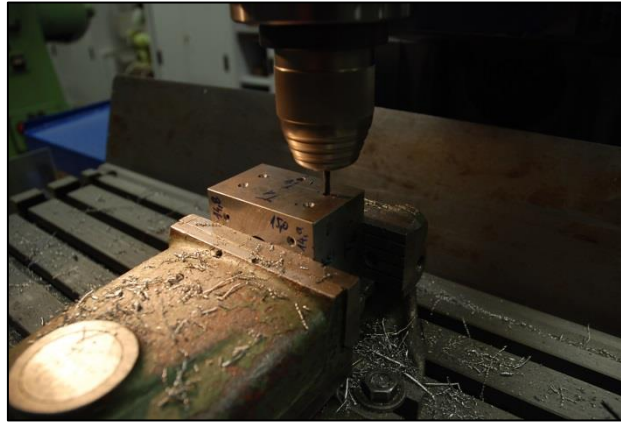
Obr. 42 Příprava děr pro termočlánky.
