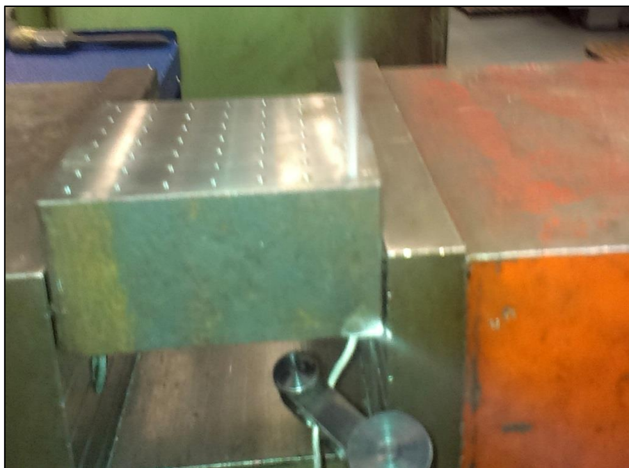
Obr. 28 Přívod CO 2 kapilárou do předvrtaného otvoru.
