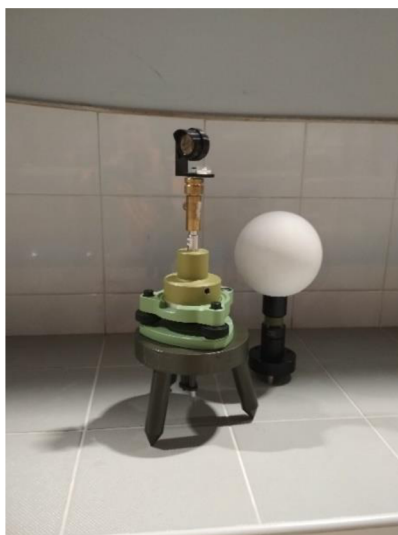
Obr. 26: Odrazný hranol Trimble M na speciálním stojanu a malá měřická koule [autor]
