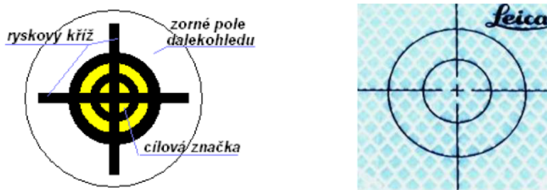
Obr. 1: Ukázka měřické značky pro úhlová měření (vlevo) a odrazné značky pro délková a úhlová měření (vpravo) [3]
