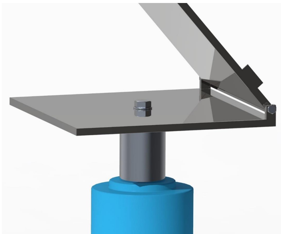
Obr. 20 Uchytenie zaťažovacej dosky o piest zdviháku
