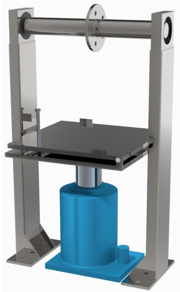
Obr. 15 Konštrukčný návrh meracieho zariadenia
