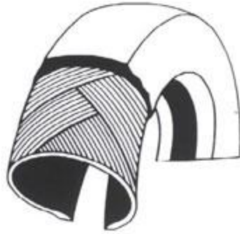
Obr. 9 Usporiadanie vlákien v diagonálnej pneumatike [19]
