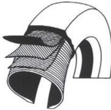
Obr. 10 Usporiadanie vlákien v radiálnej pneumatike [19]
