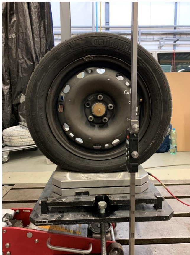
Obr. 12 Priebeh merania – zaťažená pneumatika
