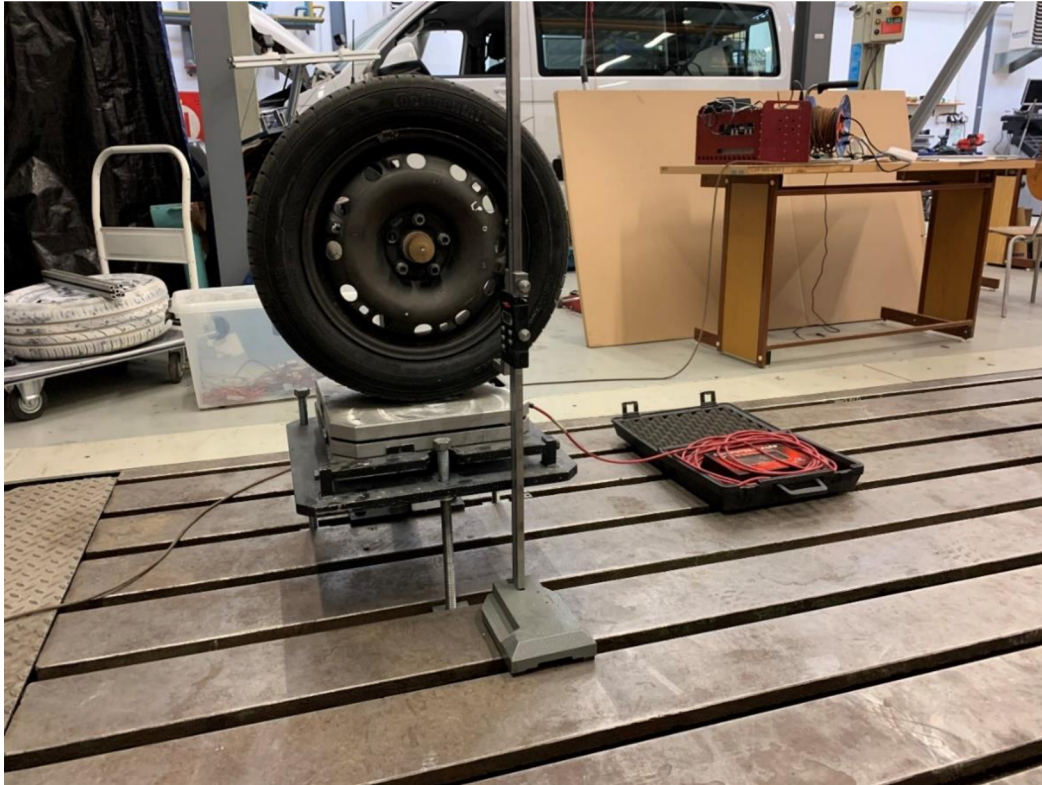
Obr. 11 Priebeh merania – nezatážená pneumatika
