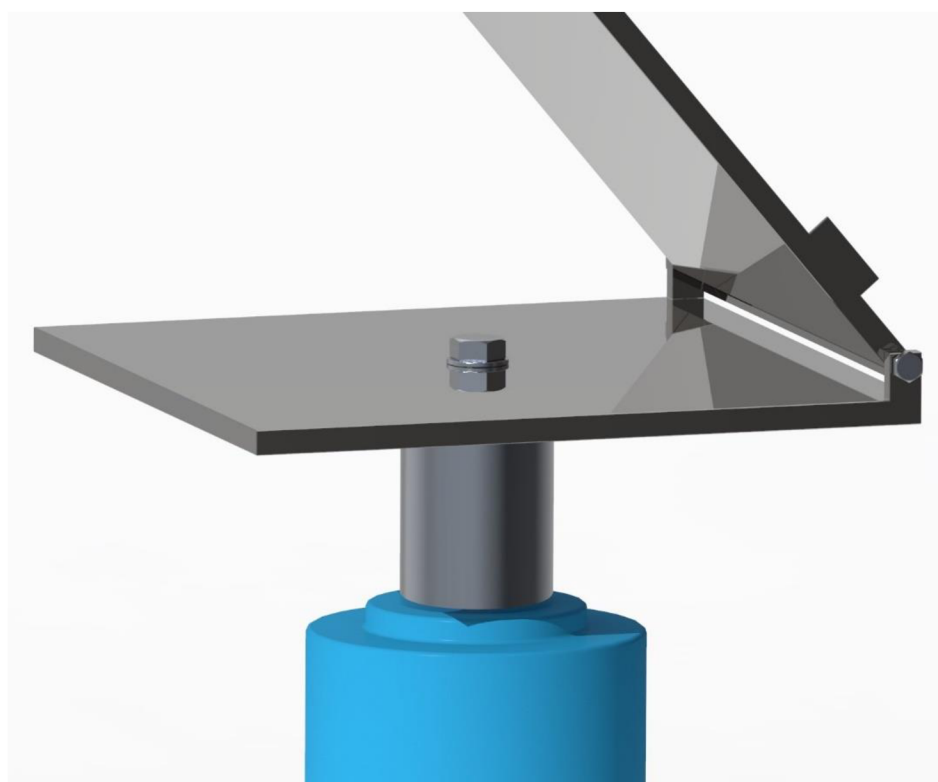
Obr. 20 Uchytenie zaťažovacej dosky o piest zdviháku
