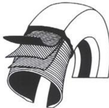
Obr. 10 Usporiadanie vlákien v radiálnej pneumatike [19]
