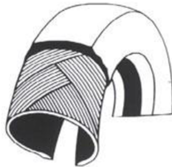
Obr. 9 Usporiadanie vlákien v diagonálnej pneumatike [19]
