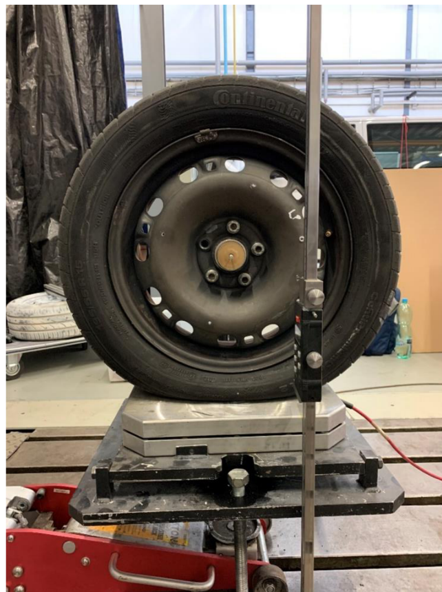
Obr. 12 Priebeh merania – zatážená pneumatika
