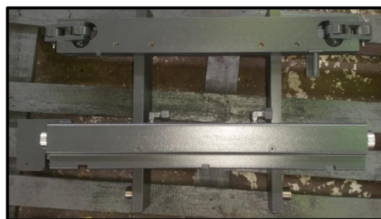
Obr. 24 Odmontovaný bočný posuv vozíka
