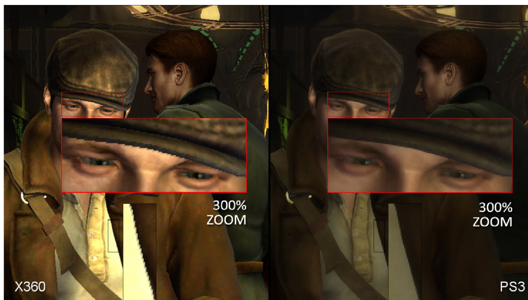
Obrázek 2.7: Ve hře Saboteur byla pro vyhlazení hran použita metoda MLAA na platformě PlayStation 3 narozdíl od platformy Xbox 360. 14
