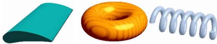
Obrázek 2.30: Vlevo útvar získaný pomocí translačního šablonování, uprostřed a vlevo příklady šablonování po šroubovici. Obrázek získán z: http://mathonline.fme.vutbr.cz/pg/Dcad/08_Sablonovani.htm
