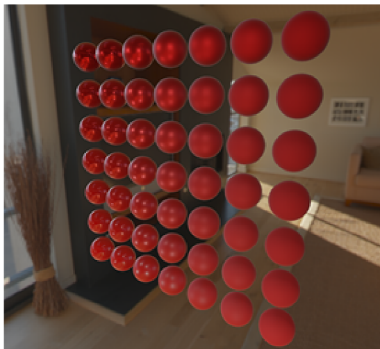
Obrázek 2.16: Koule jsou seřazeny podle hrubosti a kovovosti. Za povšimnutí stojí, že kovová, lesklá koule (vlevo nahoře) odráží celou scénu, zatímco s klesající kovovostí začnou být patrné spíše bodové zdroje světla. Obrázek získán z: https://learnopengl.com/img/pbr/ibl_specular_result.png
