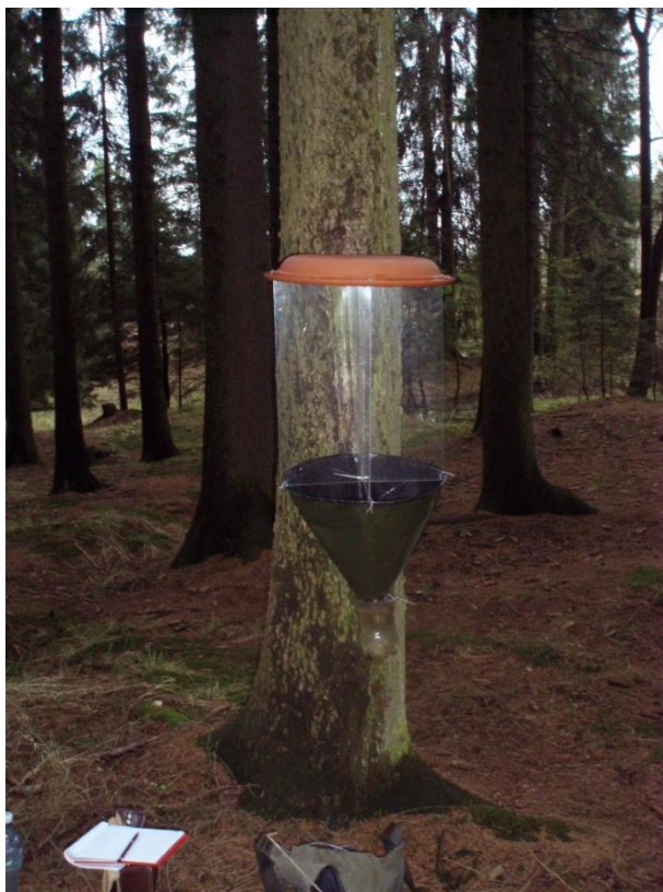
Obrázek č. 9 Pasivní nárazová past umístěná na smrku ztepilém Picea abies bez dutiny
