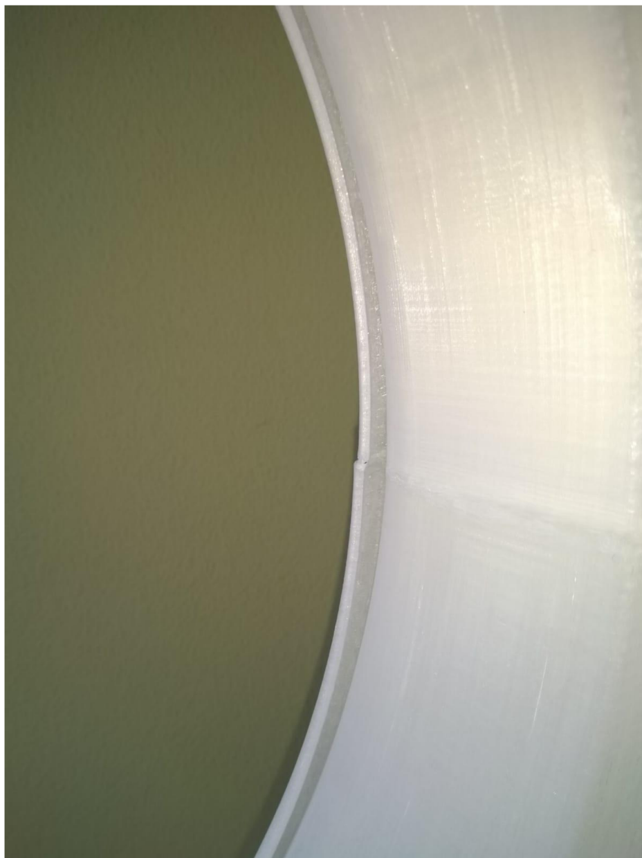
Obrázek 51: Detail štěrbiny difuzoru 1
