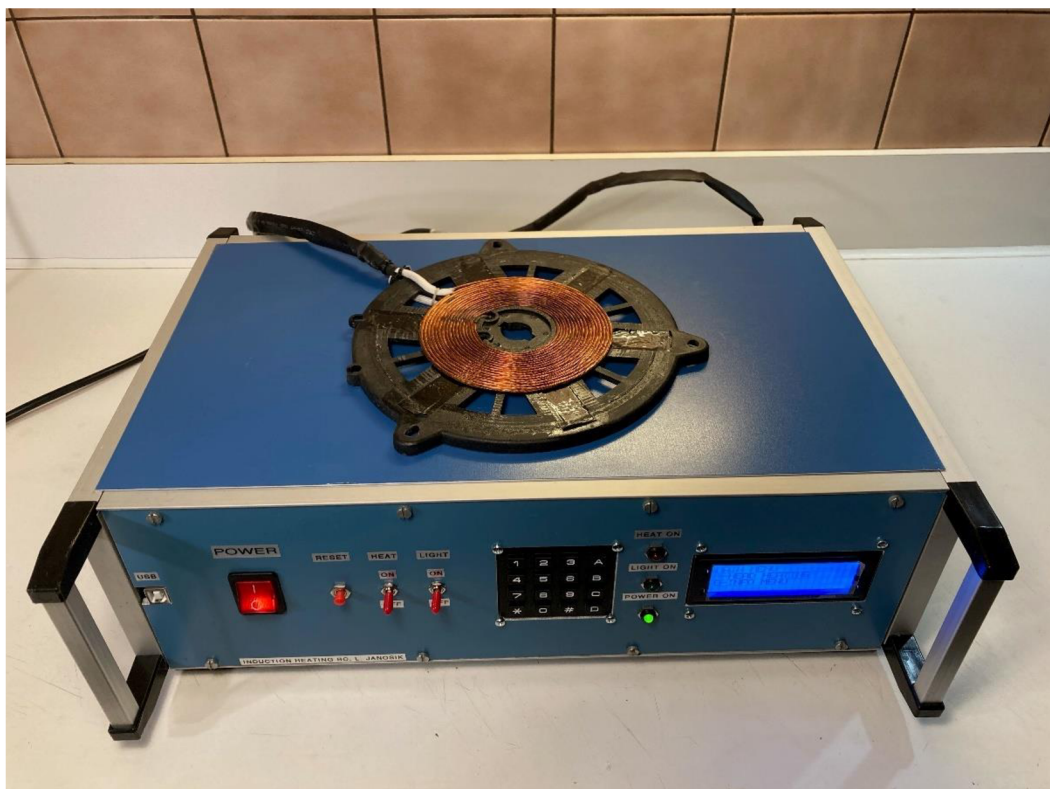
Obrázek 43: Realizovaný indukční ohřev spřádací hlavy - pohled zepředu
