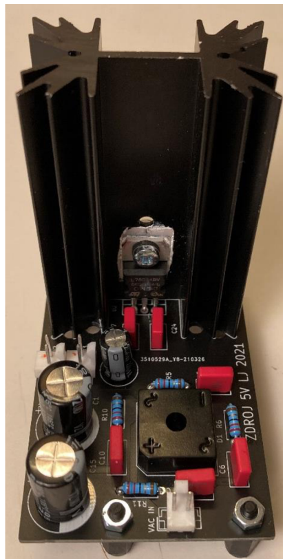
Obrázek 15: Realizovaný zdroj napětí V1 – 5 V
