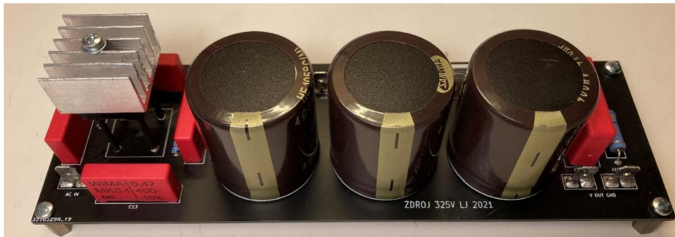
Obrázek 20: Realizovaný zdroj V3 – 75 V
