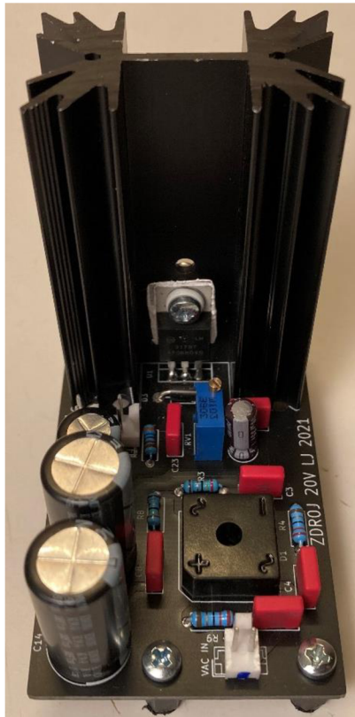
Obrázek 17: Realizovaný zdroj V2 – 20 V
