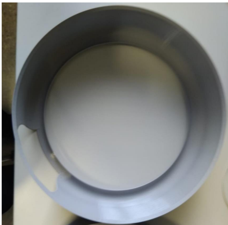
Obrázek 57: Druhá část vzduchového difuzoru ver. 2
