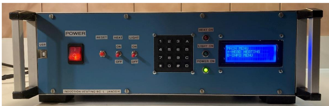
Obrázek 46: Realizovaný indukční ohřev spřádací hlavy – přední panel
