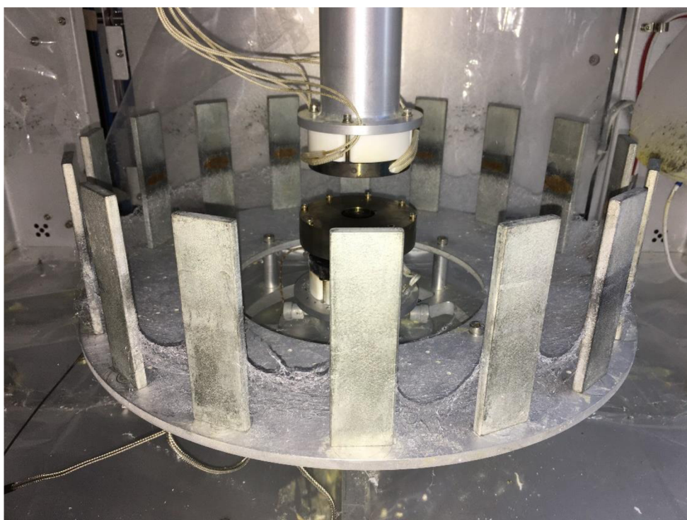
Obrázek 63: Zachycená vlákna na kolektoru
