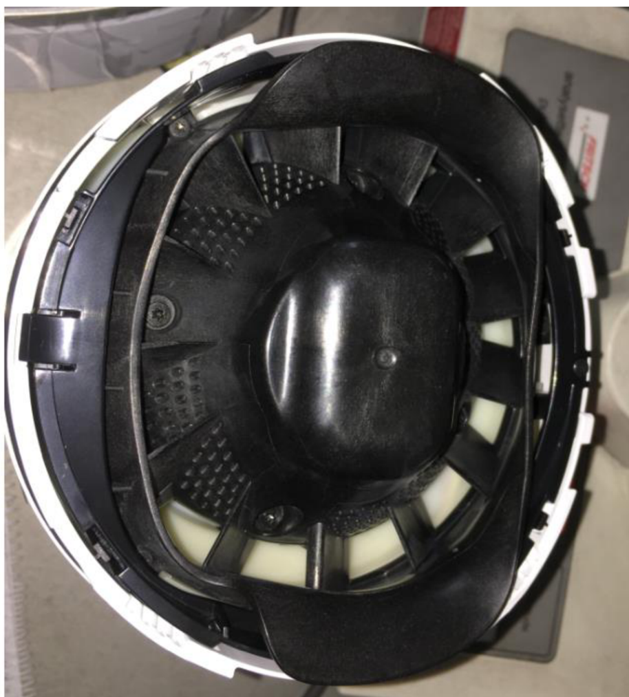
Obrázek 52: Fotografie výstupní příruby motorové jednotky ventilátoru DYSON AM6
