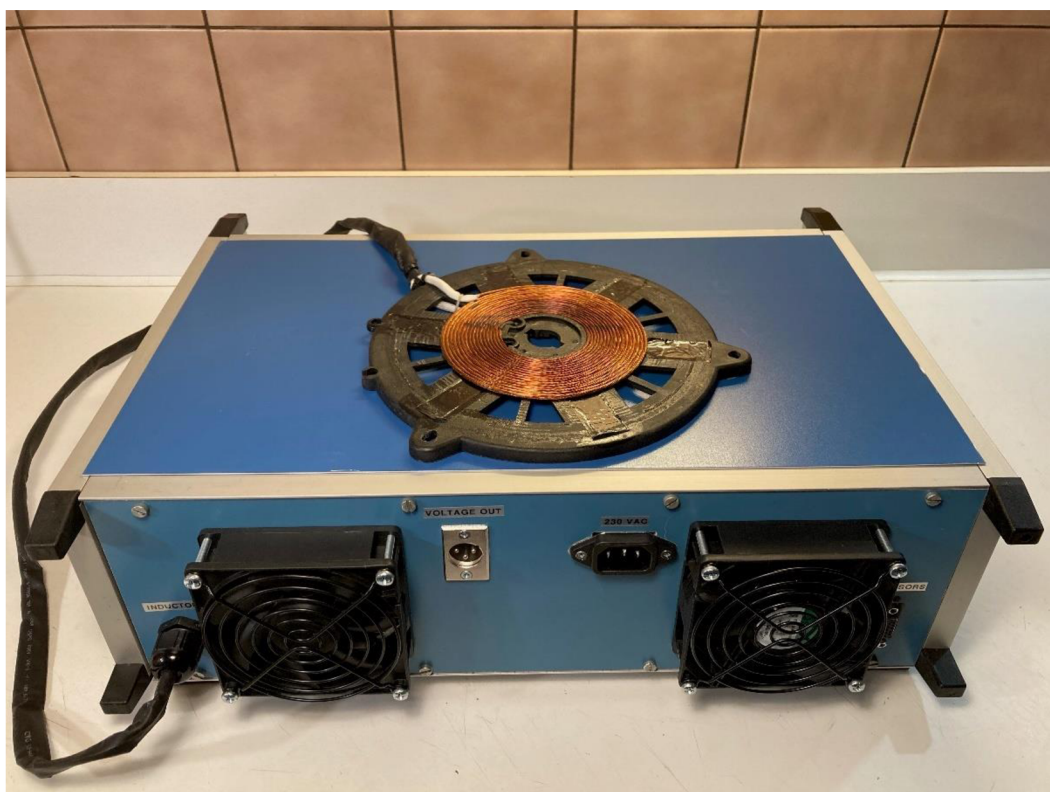
Obrázek 44: Realizovaný indukční ohřev spřádací hlavy - pohled zezadu
