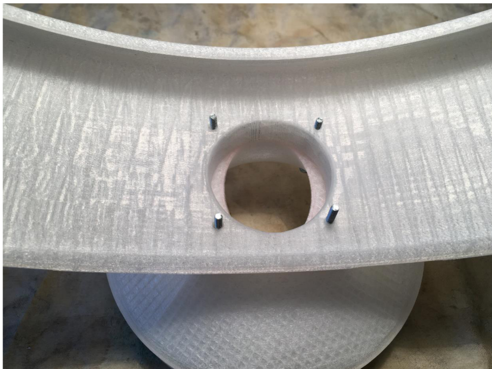
Obrázek 53: Vstupní vzduchová příruba prvního návrhu difuzoru
