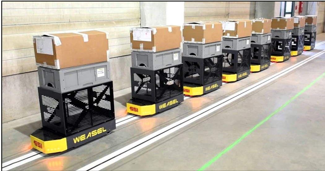
Obr. 2.1 Princip navádění AGV (snímání magnetické pásky)
