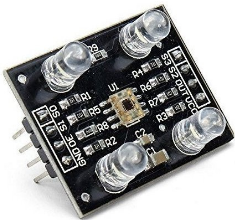
Obr. 3.5 Sensor pro detekci barev TCS3200
