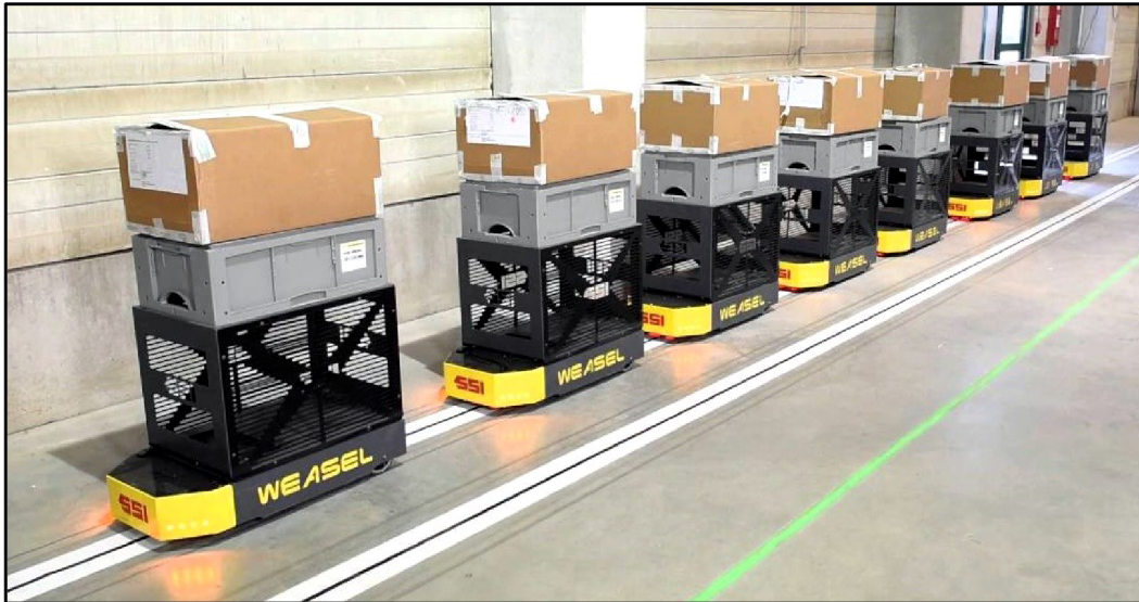
Obr. 2.1 Princip navádění AGV (snímání magnetické pásky)
