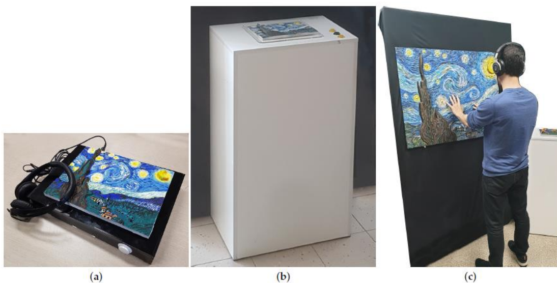
Obr. 23: Prototypy interaktivního multimodálního průvodce. (a) Přenosný prototyp, (b) Stojící výstavní prototyp, (c) Vertikální výstavní prototyp [41]
