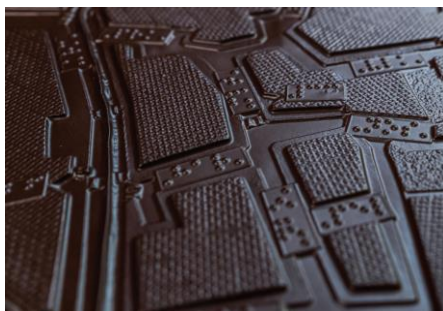
Obr. 26: Plastová fólie – technologie termovakuového formování [18]
