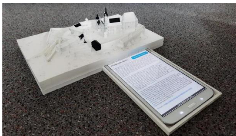
Obr. 18: Finální prototyp modelu kopce sv. Václava v Olomouci s připojeným tabletem a aplikací pro kontextové informace s funkcí převodu textu na řeč. [33]
