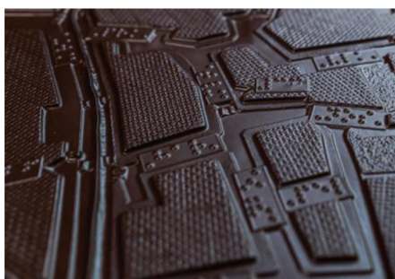
Obr. 26: Plastová fólie – technologie termovakuového formování [18]
