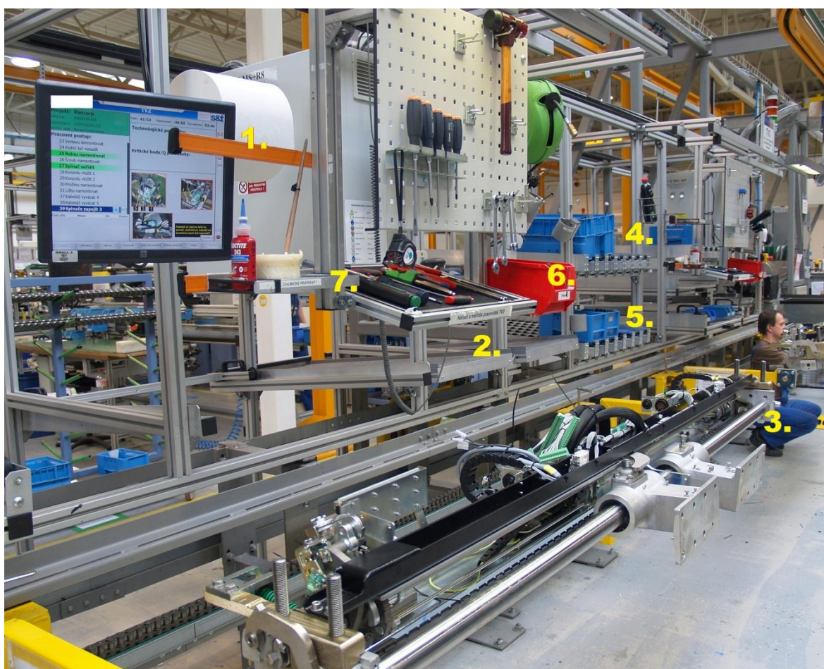
Obr. 13 Vybavenie pracoviska montážnej linky 65
